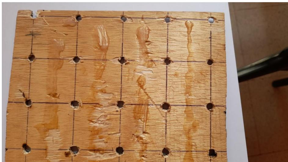
**Figure III. 14 : Méthode de sertissage et de perforation d'un panneau de bois**
