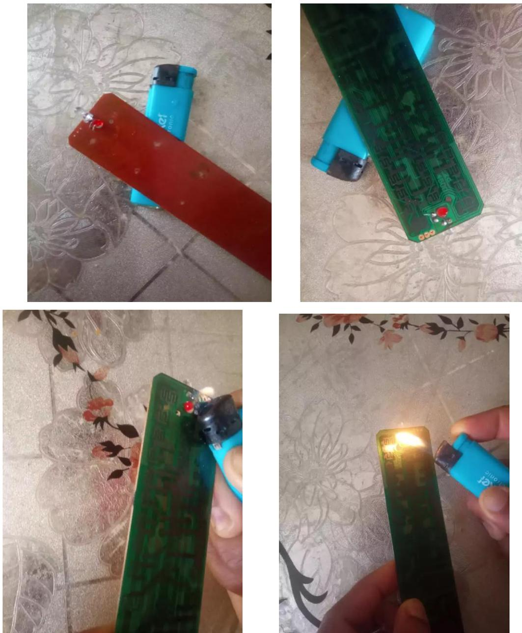
**Figure III. 3 : la suppression de la diode**
