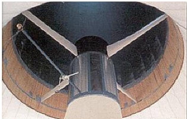
**Figure II.6 :** Turbines-génératrices pour cheminée solaire [33]
