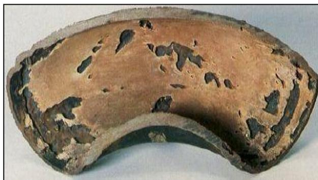
**Figure I.9 :** Corrosion d'un Coude acier carbone dans une solution sodique à T 60°C. [8,9]
