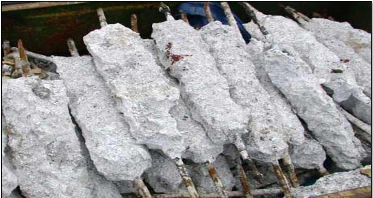
Figure II.15 : Anodes consommées (fin de sa durée de vie)
