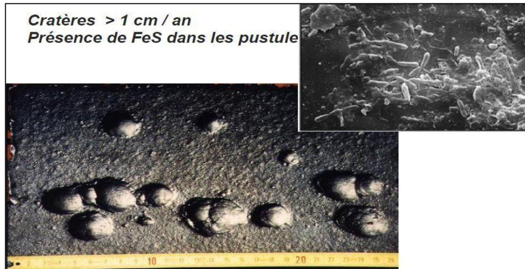
**Figure I.33 :** MIC causée par des BTR
