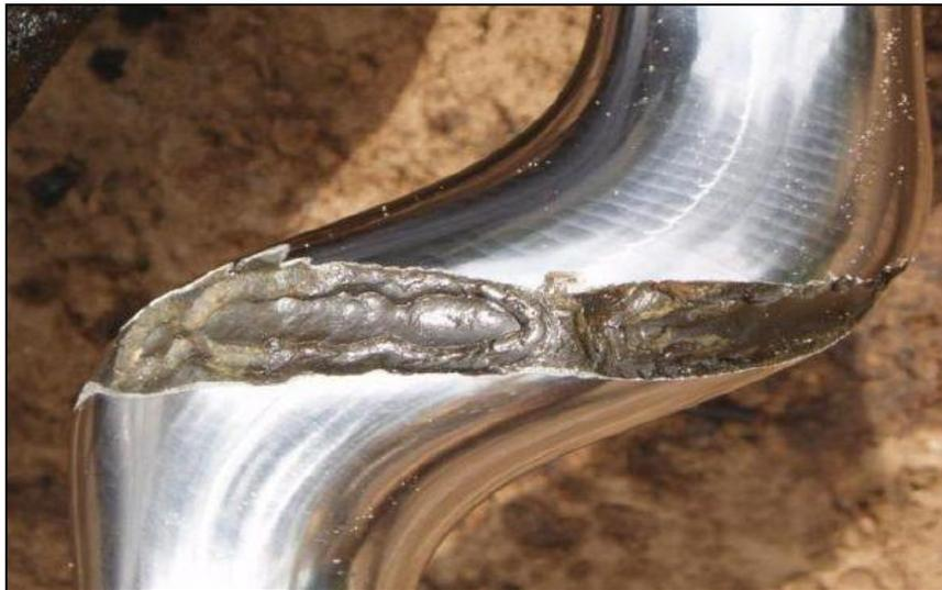
**Figure I.6 :** Corrosion galvanique (rotor d'une pompe volumétrique PCP). [8,9] Une particule de fer sur un acier inoxydable entraîne un couplage galvanique entre le fer (anodique) et l'inox (cathodique)
