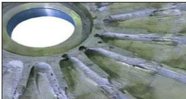
**Figure I.29 :** Exemple d'une Cavitation–corrosion d'une roue de pompe.[10]
