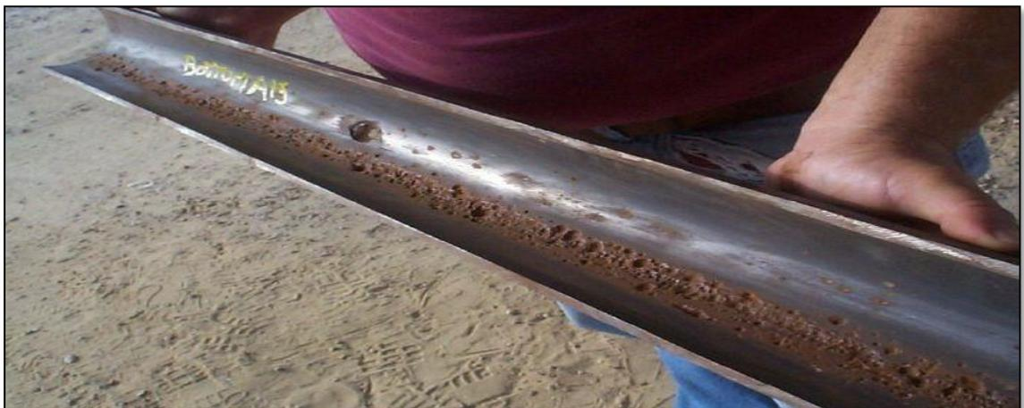
**Figure I.32 :** MIC causée par des BSR
