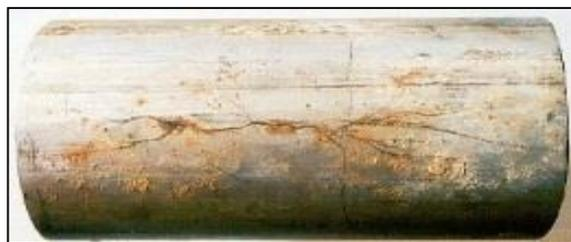
**Figure 1.8 :** Corrosion sous calorifuge d'un acier X2CrNiMo17.12.2 (AISI 316L). [8,9]
