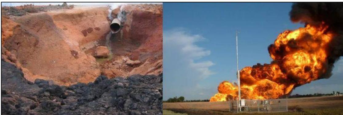
**Figure I.17 :** Eclatement d'un gazoduc par corrosion sous contrainte externe [8,9]
