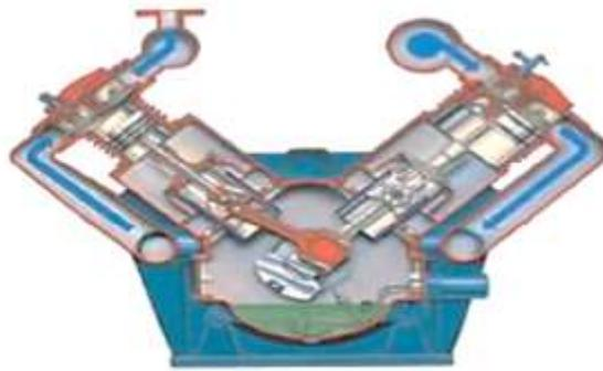
Figure 12 : Compresseur à piston
