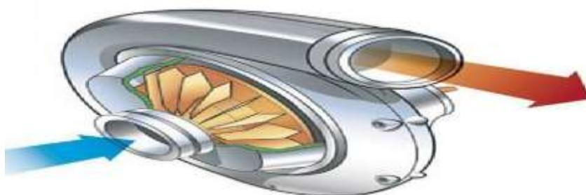
Figure 18: Compresseur centrifuges
