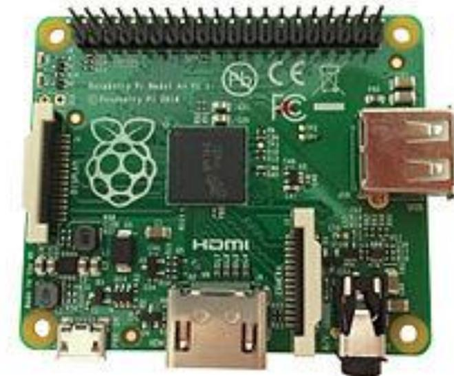
**Figure 2.3: Raspberry Pi modèle A+**
