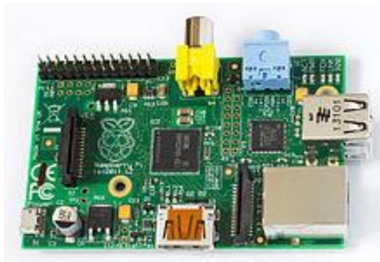
**Figure 2.4: Raspberry Pi modèle B Rev. 2**
