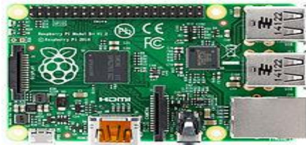
Figure 2.6: Raspberry Pi modèle B+
