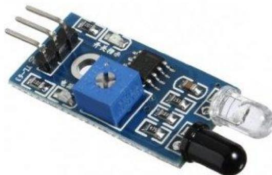
Figure 4.2: Capteur d'évitement d'obstacle
