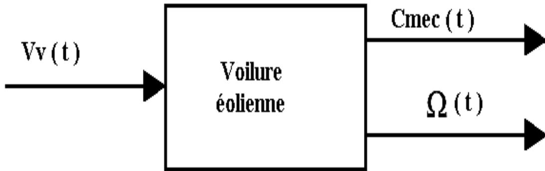
Figure III.5 : Modèle de la voilure
