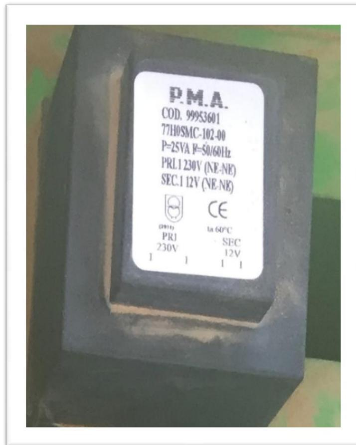
*Figure 26: Transformateur 12V*
