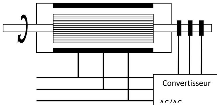
**Fig. (I-2) :** Principe de la machine à double alimentation standard.
