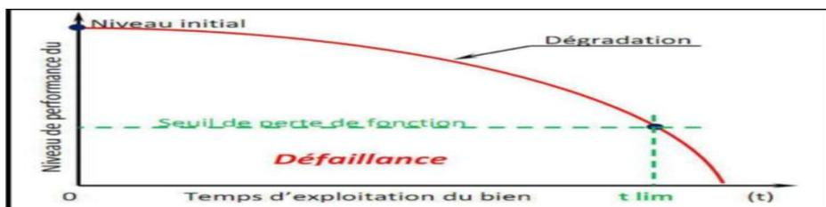
FIG 3.7 Dégradation du bien et durée de vie
