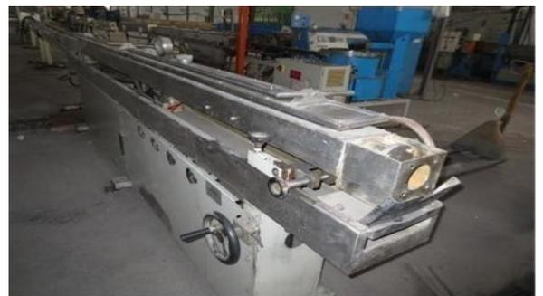
**FIG 3.5 une machine de fabrication des tubes PE**
