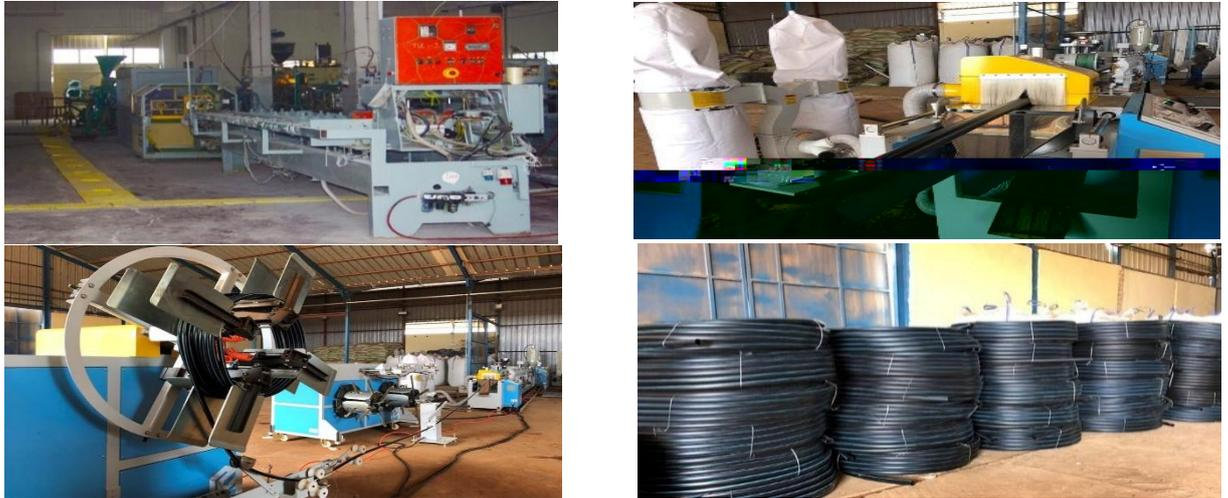
**FIG 3.4 les différents étapes de fabrication des tube PEHD**
