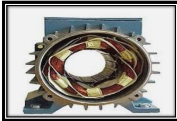
Figure (I.3): stator d'un moteur asynchrone triphasé après le bobinage [9]
