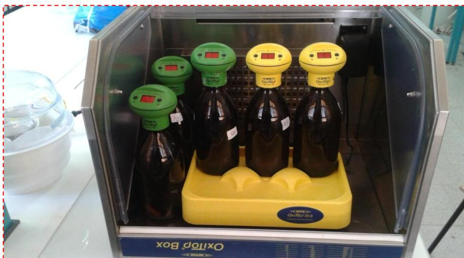
**Photo N°12 - Appareil de demande biochimique en oxygène DBO<sub>5</sub>**
