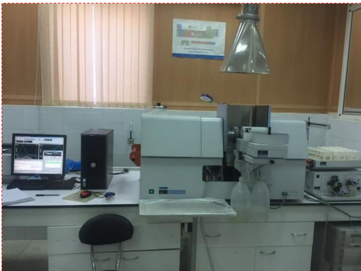
**Photo N°13 –Spectroscopie absorption atomique (Perkin-Elmer AA800)**
