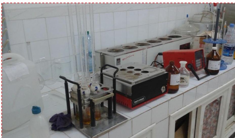
Photo N°11 - Appareil de demande chimique en oxygène DCO
