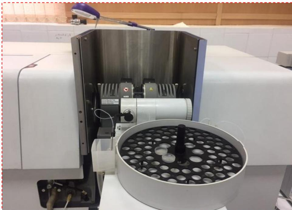
**Photo N°14 –Porte d'échantillons au Spectroscopie absorption atomique
