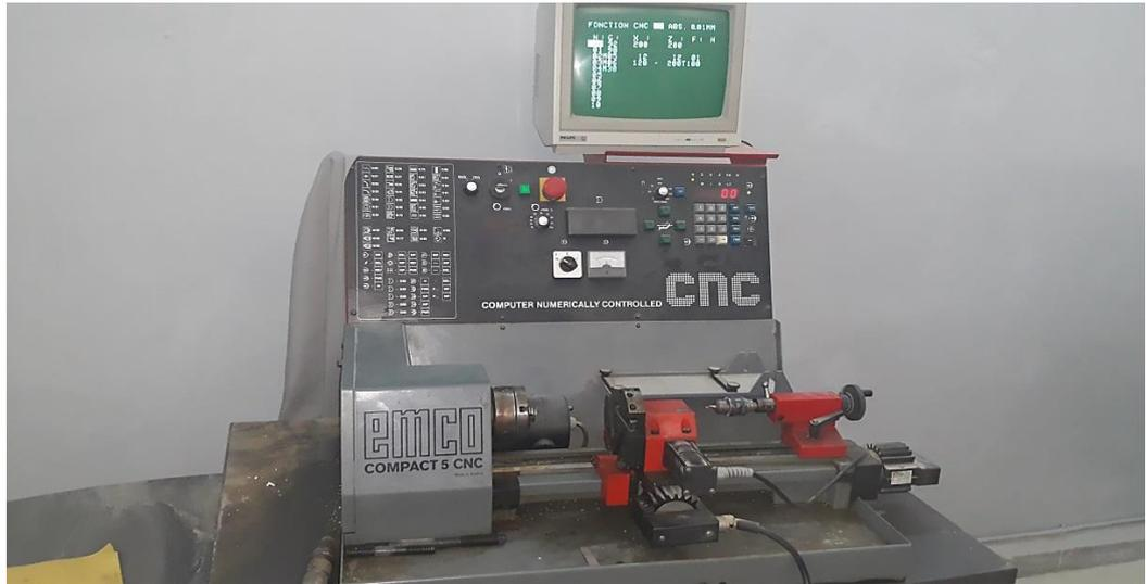
Figure II.5 : EMCO Compact 5 CNC (laboratoire de commande numérique, Université de Ouargla)
