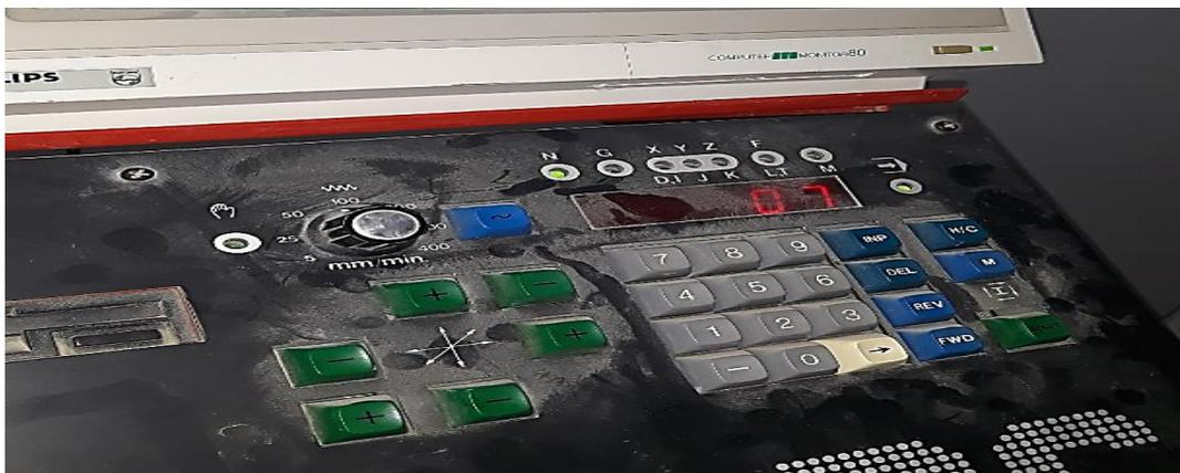
Figure IV.6 : clavier de partie commande Manuel de CNC
