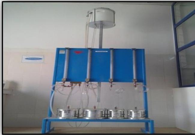
*Photo I -8-Appareille de l'essai de perméabilité.*
