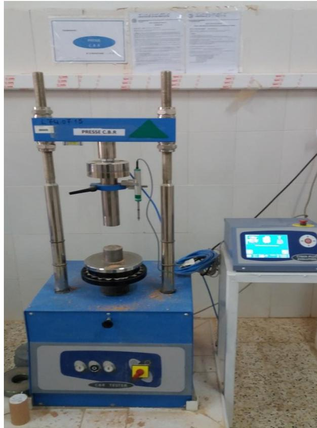
*Photo I-6-Appareille de l'essai CBR.*
