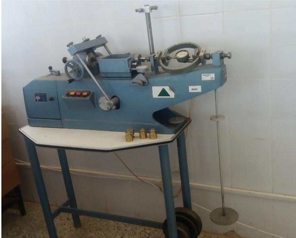
*Photo I-7-Appareille de l'essai cisaillement direct.*
