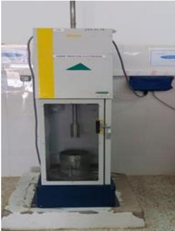
*Photo I-3-Apparaille de l'essai Proctor modifié.*
