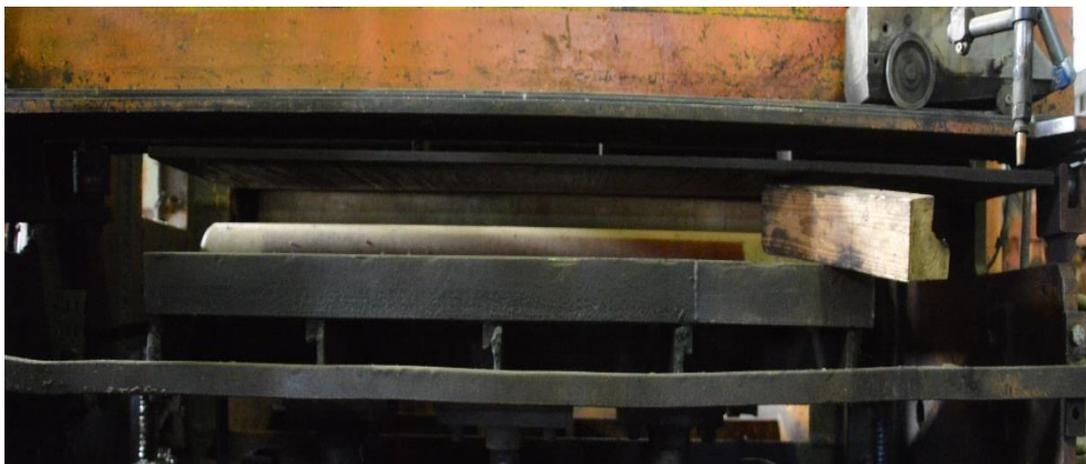
**FIGURE 7 : DISPOSITIF D' ÉQUERRAGE.**
