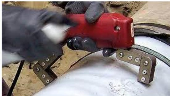
**FIGURE 2 : LA MAGNÉTOSCOPIE**
