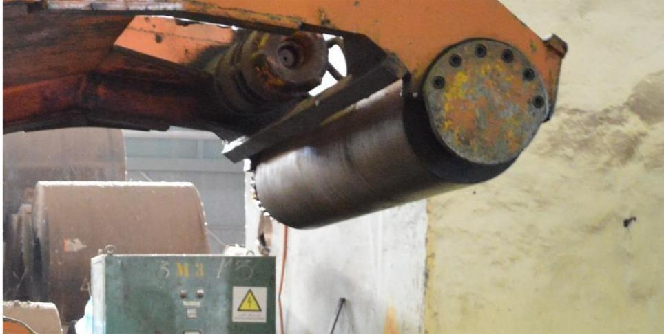
**FIGURE 4 : DISPOSITIF DU ROULEAU SUPÉRIEUR.**
