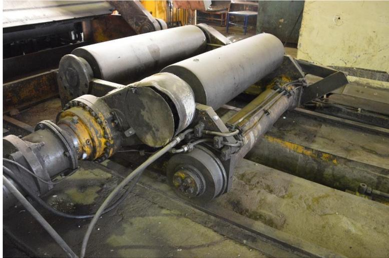
**FIGURE 2 : CHARIOT DE ROTATION BOBINE.**
