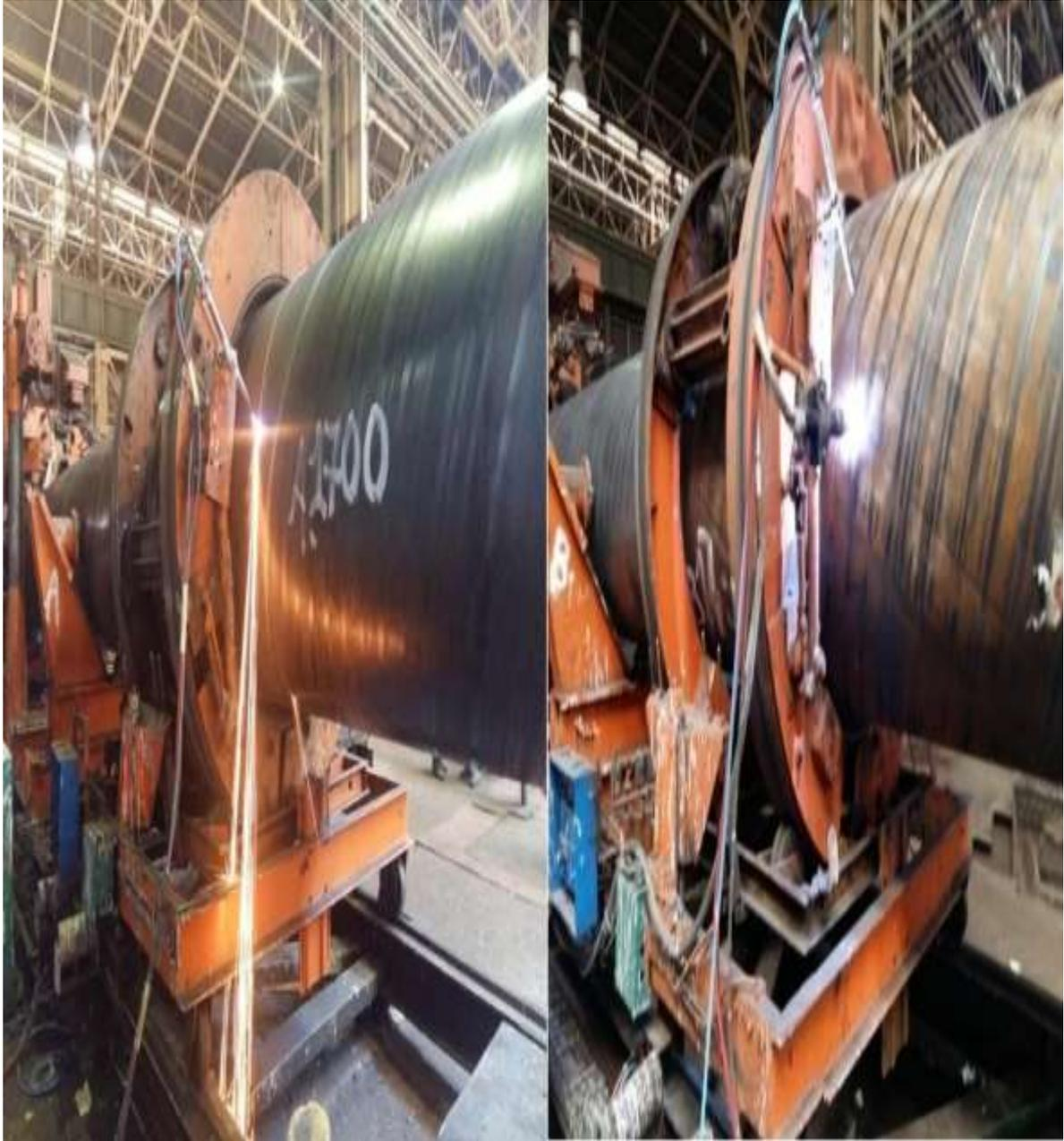
Figure III.6. Oxycoupage par chalumeur
