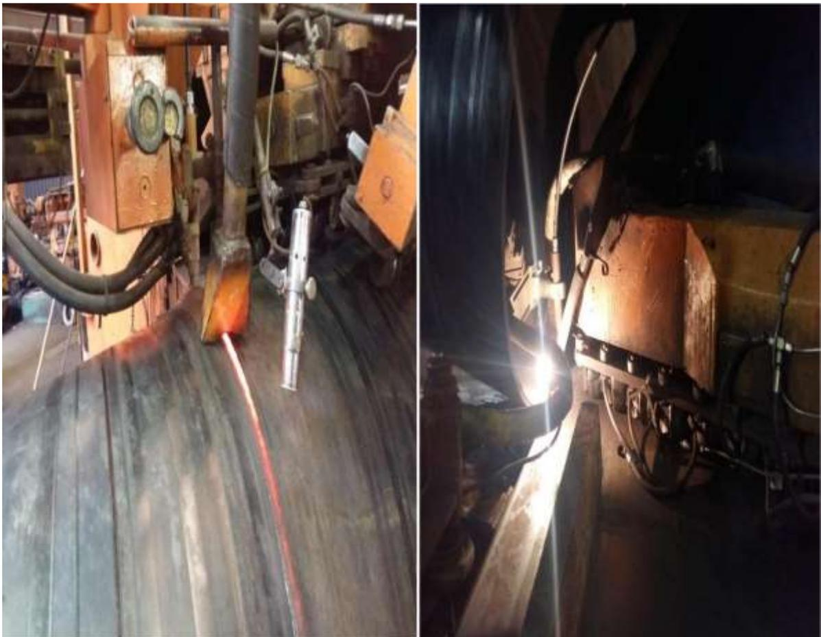
**Figure III.4. Soudage extérieur de tube**    **Figure III.5. Soudage intérieur de tube**
