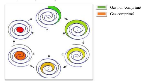
Figure II-9 : Schéma de cycle de compresseurs à spirales [3]
