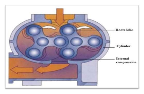
Figure II-10: Compresseurs rotatifs à lobes
