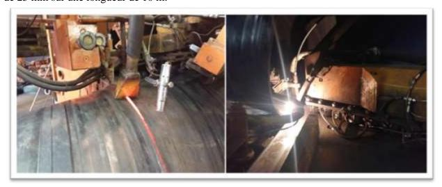
Figure I-27: soudage extérieur et int de tube
