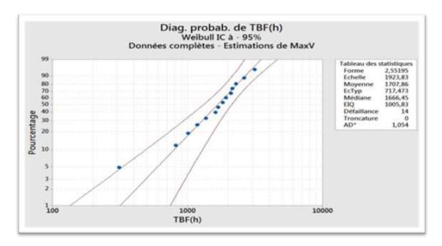
Figure IV-2: papier de Weibull en logiciel minitab17
