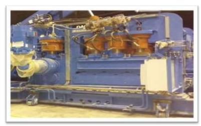
Figure I-7: Dispositif de dressage.
