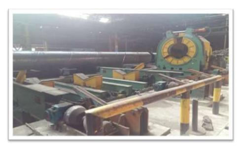
Figure I-23: Vue de la chanfreineusede tubes.
