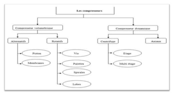
Figure II-1: Classification des compresseurs
