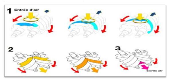
Figure II-12: Principe de fonctionnement des deux rotors du compresseur [11]
