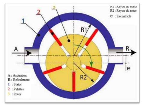
Figure II-8 : Principe de Compresseurs rotatifs à palettes
