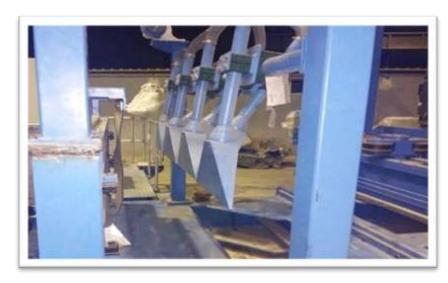
Figure I-12 Nettoyage de feuillard.
