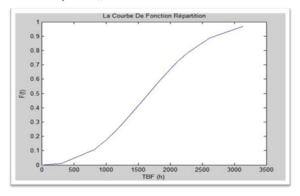
Figure IV-4: La Courbe De Fonction Répartition (logiciel matlab)
