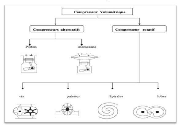
Figure II-6 : Les types des compresseurs volumétriques [2]
