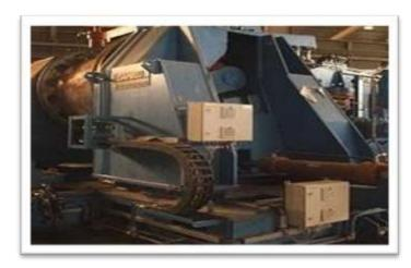
Figure I-5 : Supports de bobine (dévidoir).
