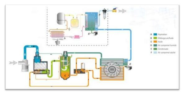
Figure II-14 : Schéma du compresseur ATLAS-COPCO – ZE3
