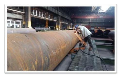
Figure I-21 : réparation des défauts manuellement
