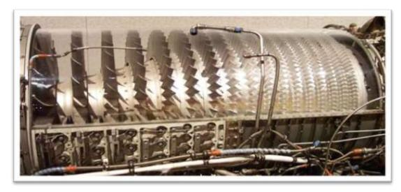
Figure II-3: Compresseur axiaux du GE J79
