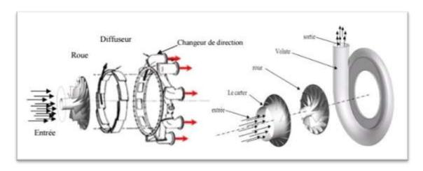
Figure II-5 : Compresseur centrifuge – vue éclatée
