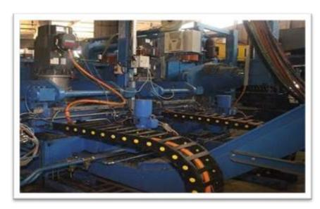
Figure I-10 Dispositif de fraisage.
