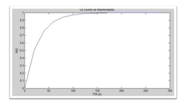
Figure IV-7: La Courbe de Maintenabilité (logiciel matlab) Analyse de la courbe :
