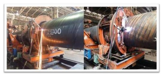
Figure I-28: Oxycoupage par chalumeur et par plasma
