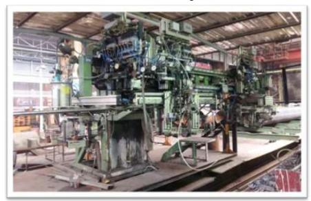
Figure I-24: machine de contrôle ultrason automatique
