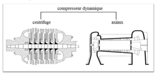
Figure II-2: Les types des compresseurs dynamiques [2]
