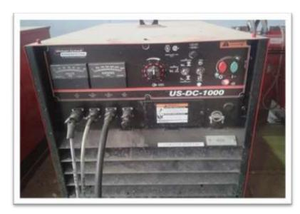
Figure I-16 : Poste de soudage extérieur.
