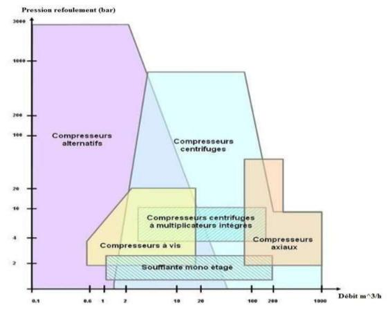
Figure II-15: Types de compresseurs en fonction de débit et de la pression [2]
