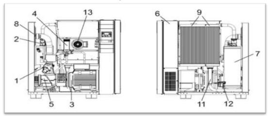
Figure II-13: Composantes du compresseur à vis [11]
