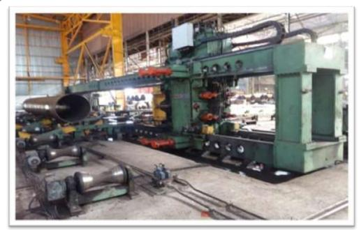
Figure I-22: La machine d'essais hydrostatique
