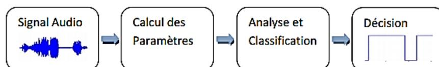
FIGURE 3.9 – Processus général d'un algorithme de la DAV [26]
