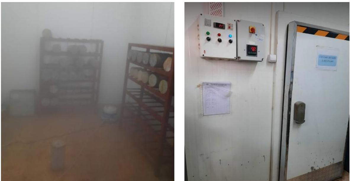
Figure III.3. Mode de conservation des éprouvettes.
