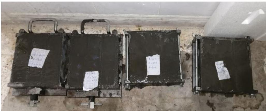
**Figure III.2. Moule normalisé de  $4 \times 4 \times 16 \text{ cm}^2$ .**
