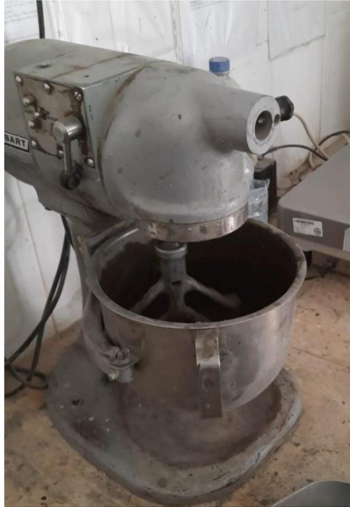
**Figure III.1. Malaxeur normalisé pour pâte et mortier.**
