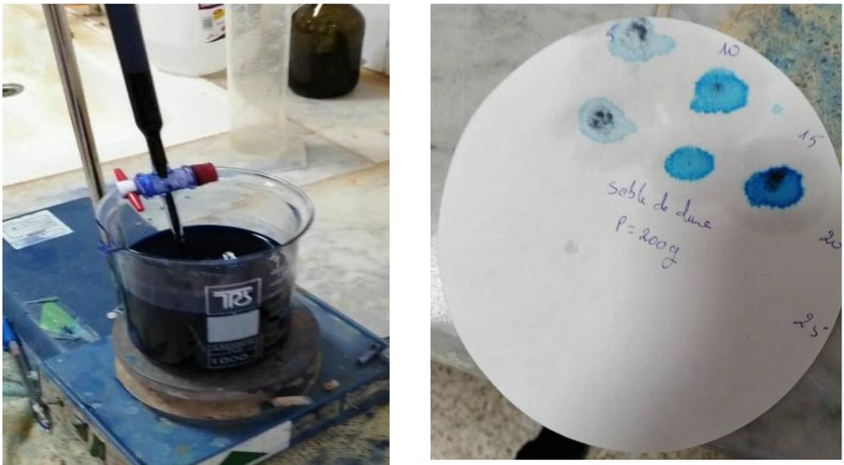
**Figure II.5. Analyse de bleu méthylène.**
