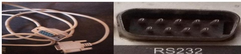
Figure IV.3 Le connecteur mâle et femelle de câble RS232
