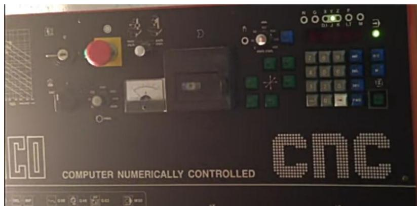
Figure IV.2 Clavier de la partie commande du tour EMCO COMPACT 5 CNC
