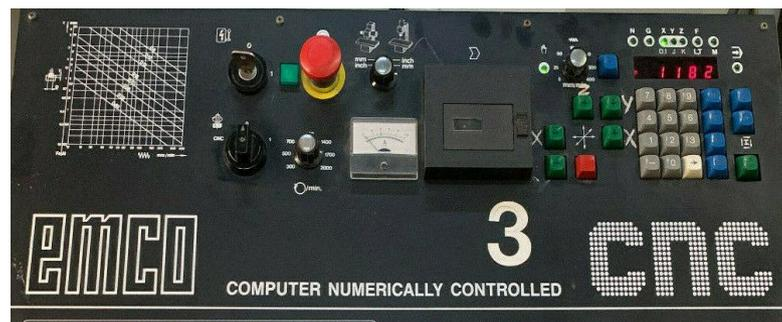
**Figure IV.11** Clavée de la partie commande d'une fraiseuse EMCO F1 CNC
