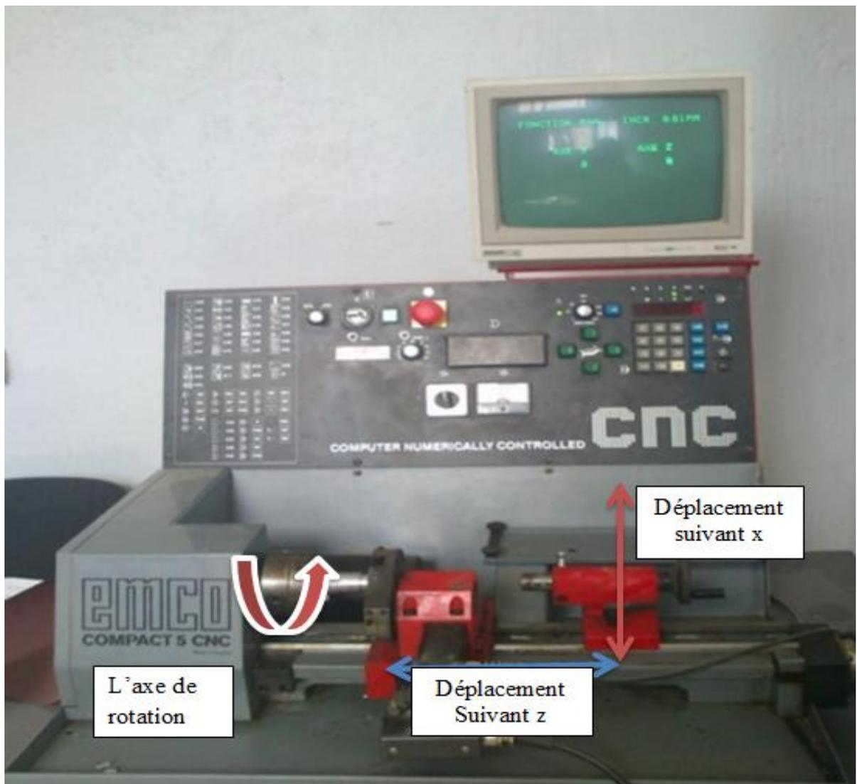
**Figure II.8** Les axes de déplacement de tour EMCO COMPACT 5 CNC
