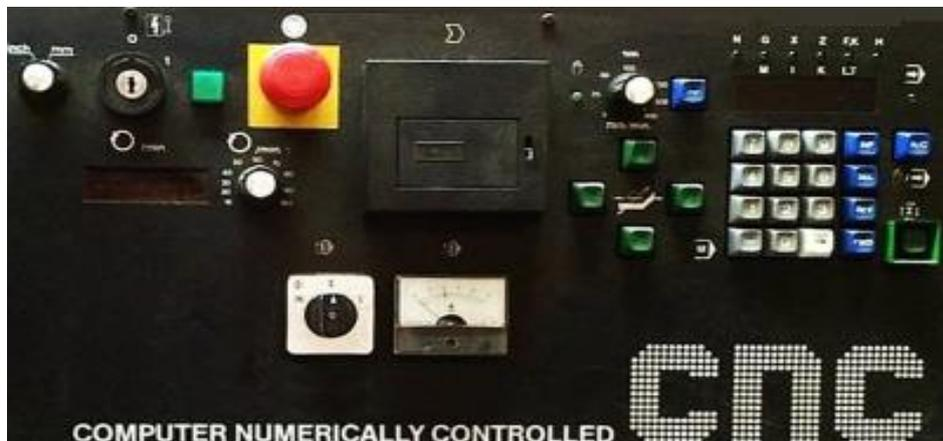
**Figure IV.18** Clavée de la partie commande d'une tour EMCO COMPACT 5 CNC
