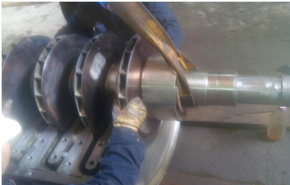
**Figure III.8** Soulever avec précaution le rotor bien équilibré
