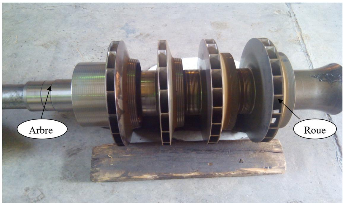
**Figure II.4** rotor de compresseur BCL 504
