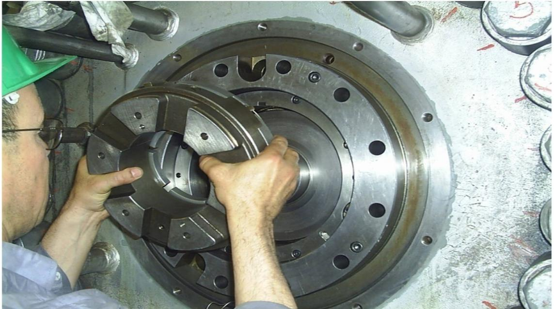
**Figure III.19** Monter le palier de butée active
