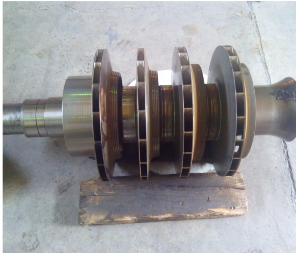
**Figure III.12** Faire un contrôle dimensionnel de l'arbre
