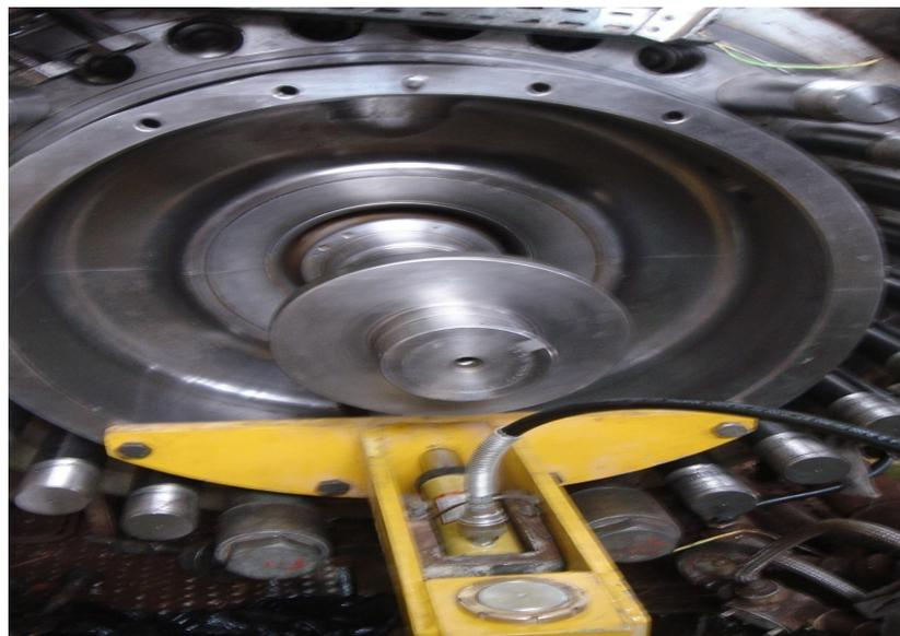
**Figure III.6** le dispositif d'extraction du paquet diaphragme
