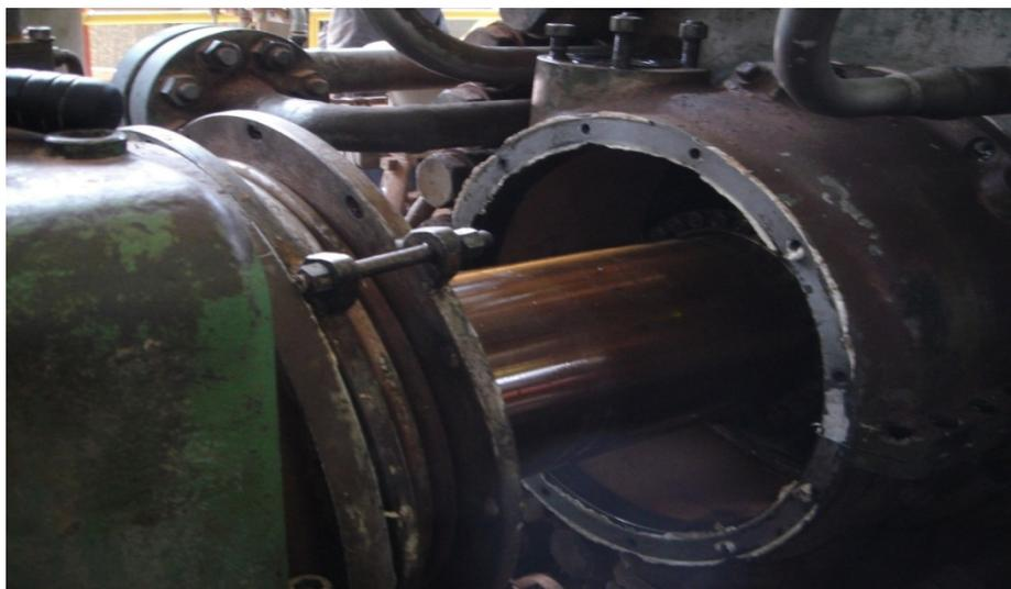
**Figure III.3** Déposer le cache accouplement
