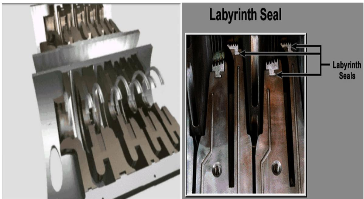
**Figure III.14** Mettre en place les nouveaux labyrinthe [11]
