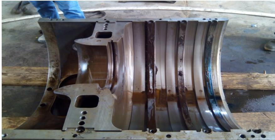
**Figure III.9** Démontez les diaphragmes et les déposer sur des madriers
