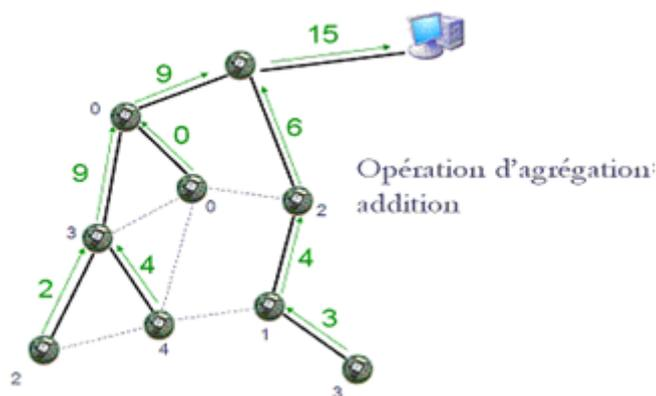
FIGURE 2.1: Fonctionnement de l'agrégation des données dans RCSF [17]
