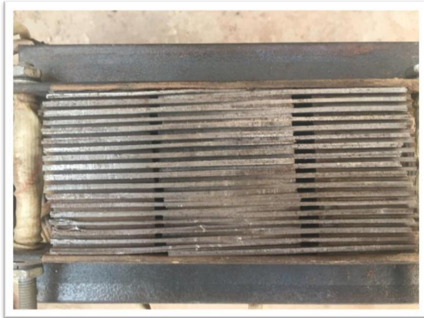
*Figure III.4: Noyau du circuit magnétique du transformateur*
