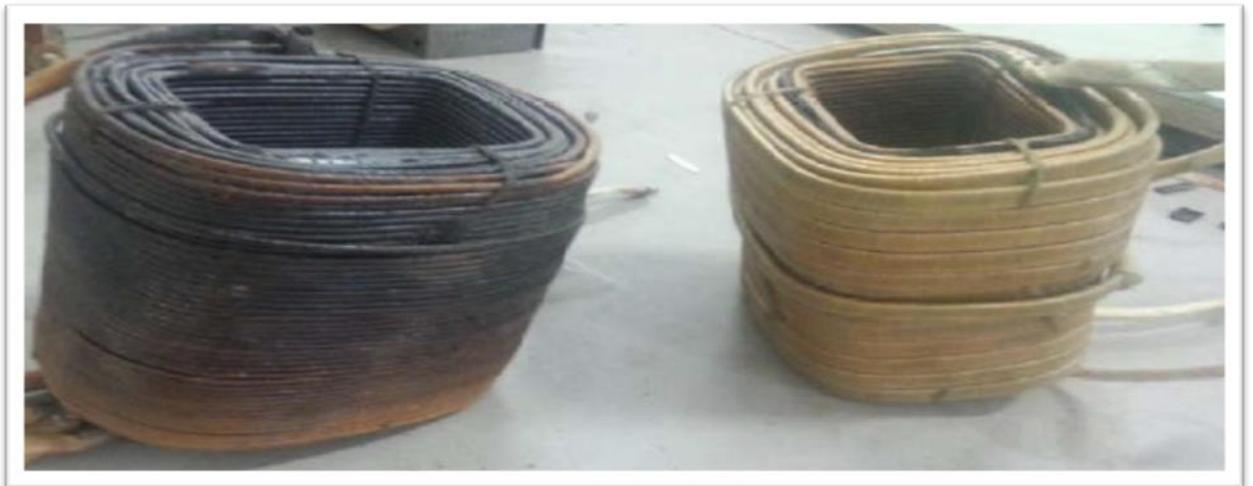
*Figure III.3: Bobinage primaire endommagé (gauche) et bobinage secondaire intact (droit).*
