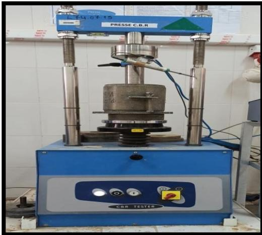
**Photo II-13:** échantillon lors de poinçonnement
