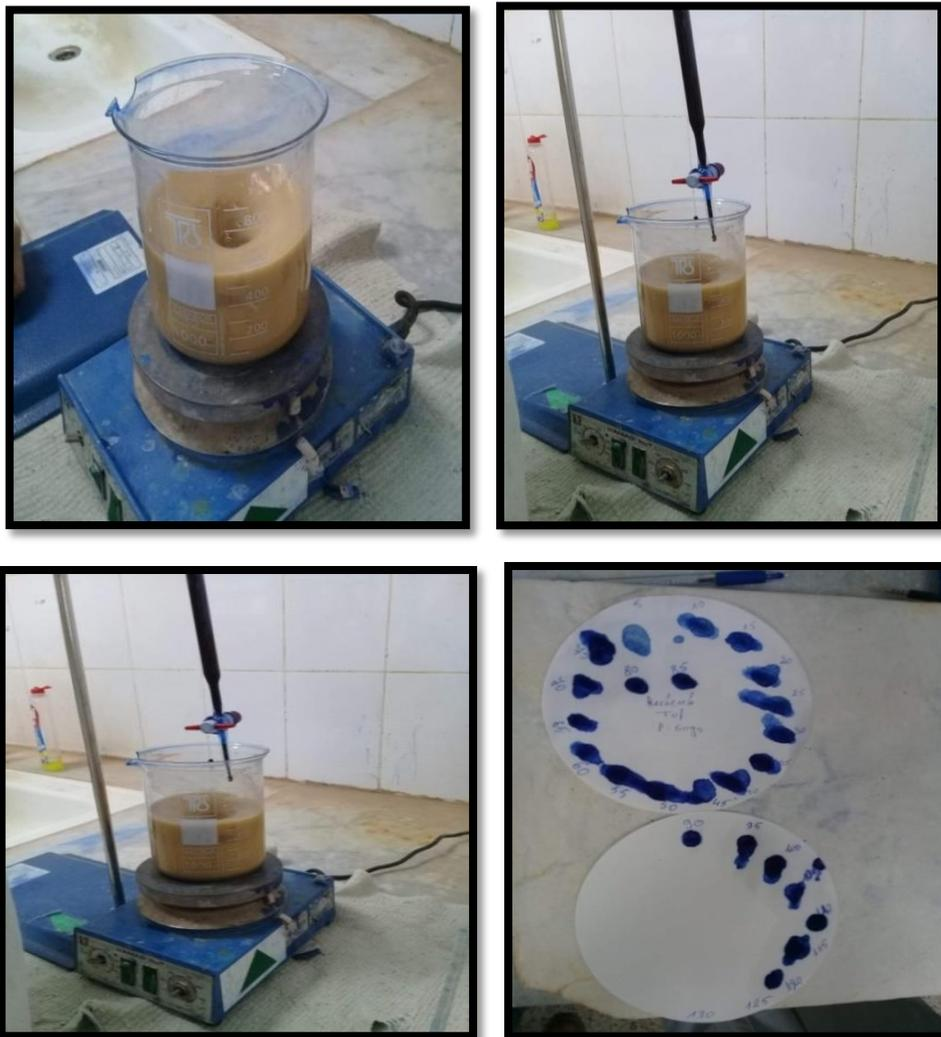
*Photo II-9 : principe et résultats d'Essai au bleu de méthylène*
