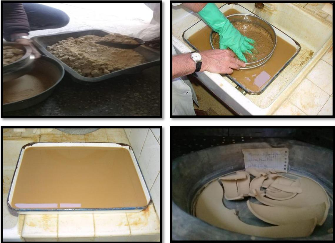
**Photo II-5 :** siphonage et imbibitions de l'échantillons de limite d'Atterberg.
