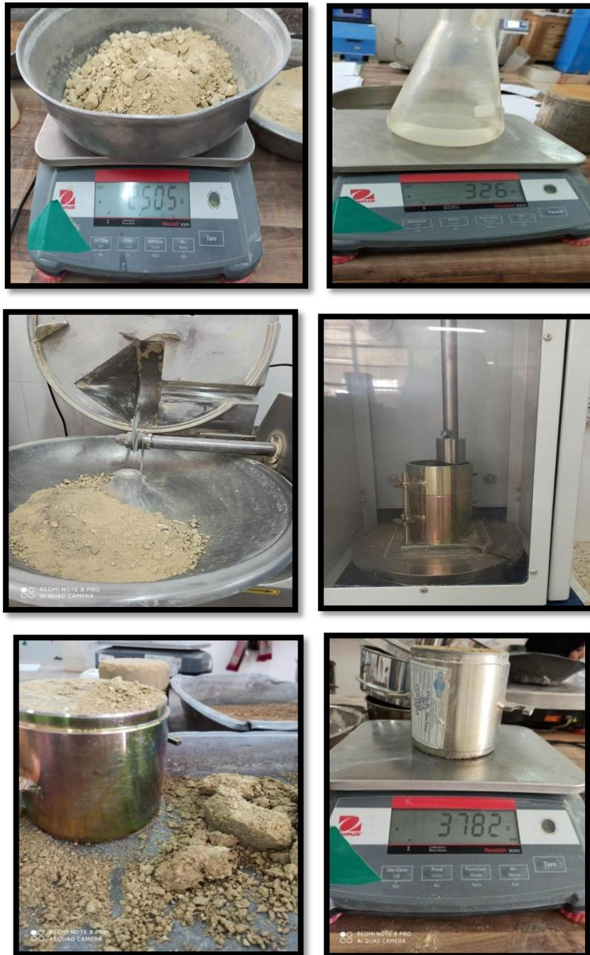
**Photo II- 11 :** essai Proctor modifié.
