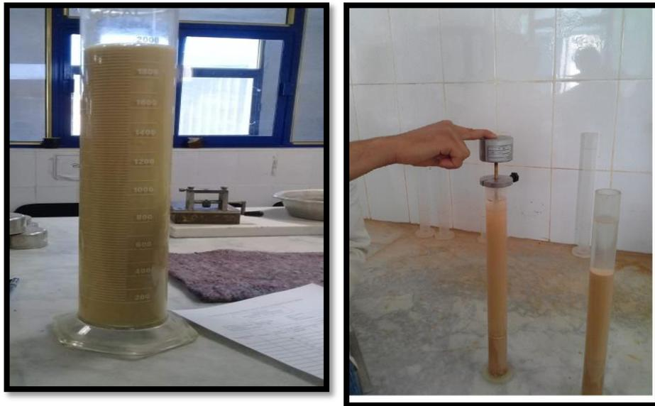
*Photo II- 8: Essai de L'équivalent de sable*
