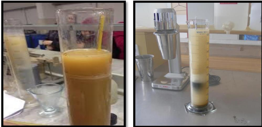
**Photo II-4:** l'essai de granulométrie par sedimentometrique
