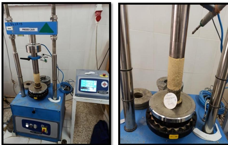
Photo II-19 : écrasement des éprouvettes dans la presse CBR
