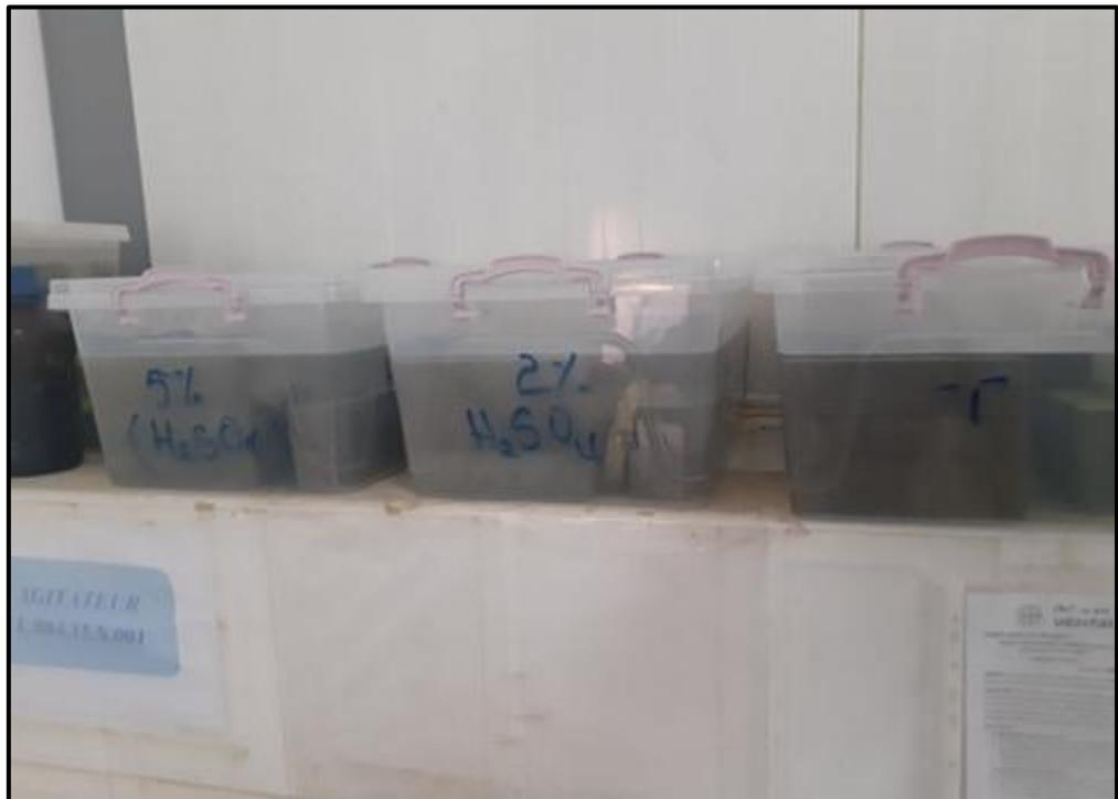
(Figure III.19) : Les trois milieux de conservation d'éprouvettes
