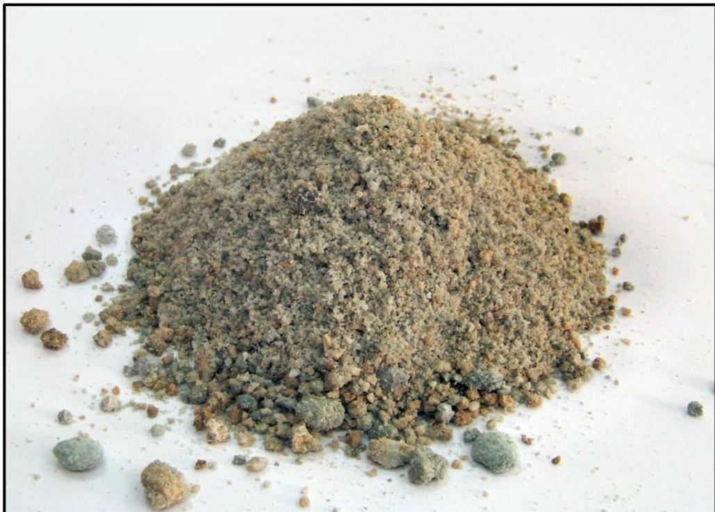
(Figure II.6) : Laitier de haut fourneau
