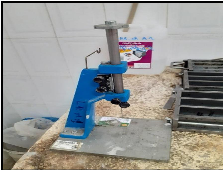
(Figure I.5) : Appareil de Vicat
