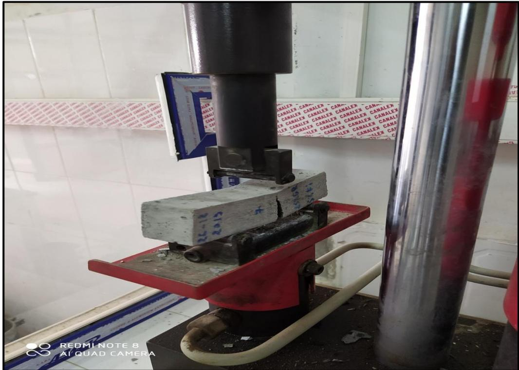
(Figure III.21) : Machine d'essai de résistance à la flexion
