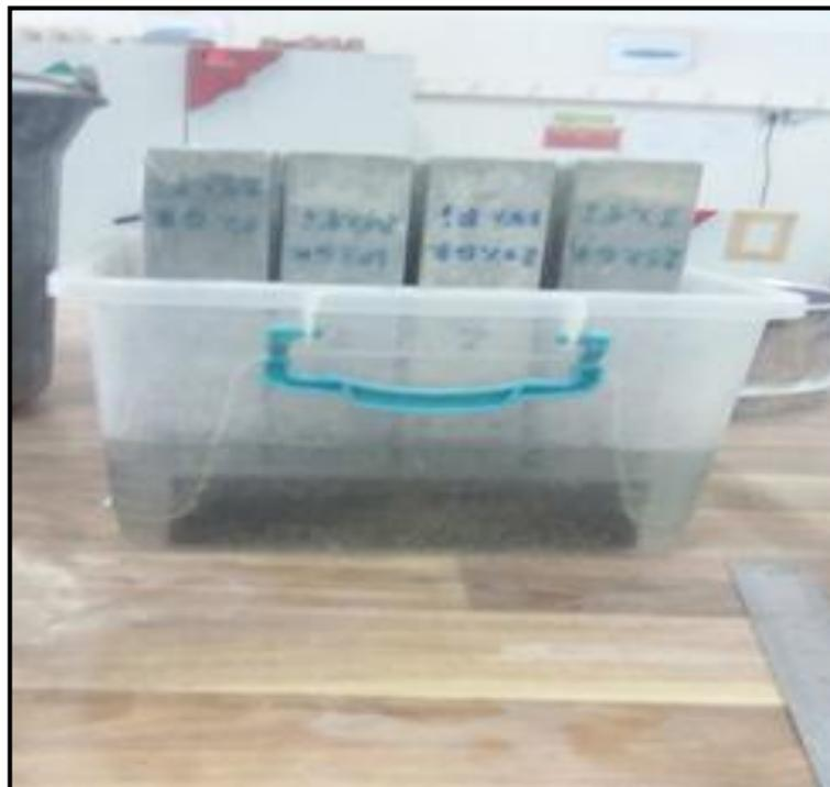
(Figure III.24) : Les échantillons en contact avec l'eau
