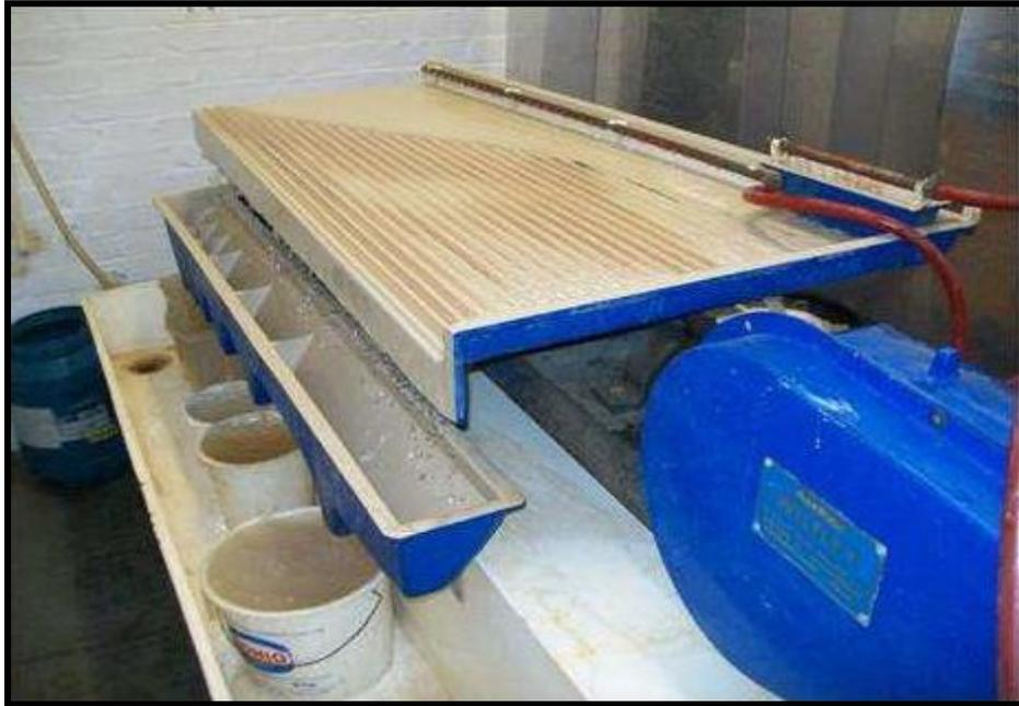
(Figure I.4) : Table à secousse
