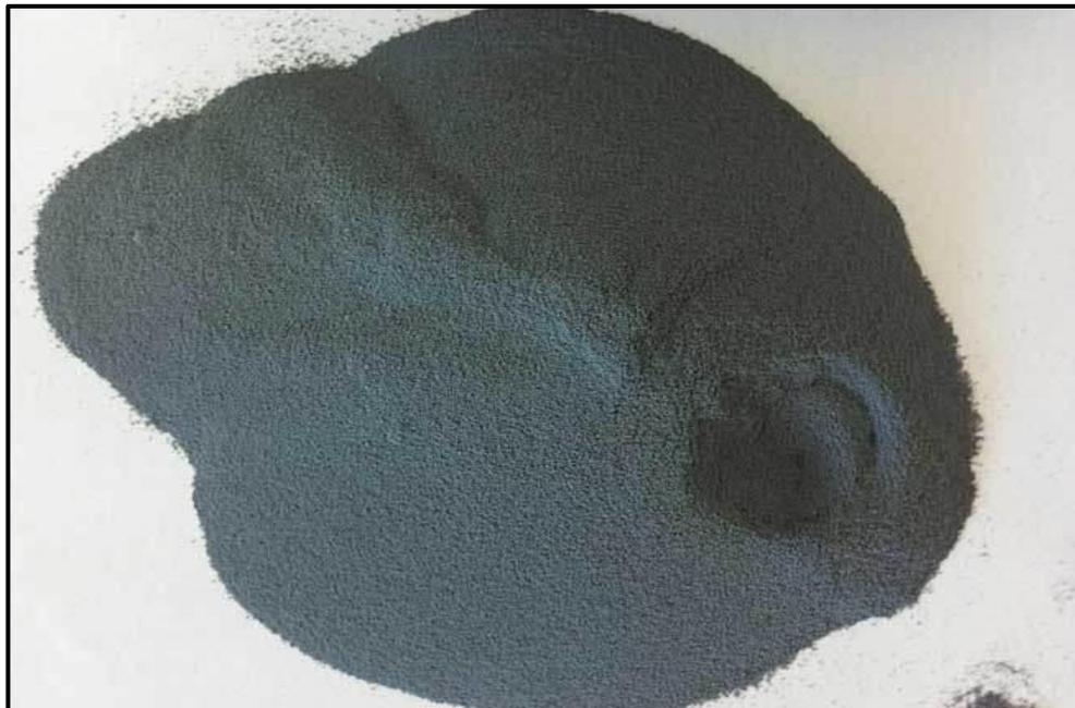
(Figure II.9) : Poudre de Fumées de silice
