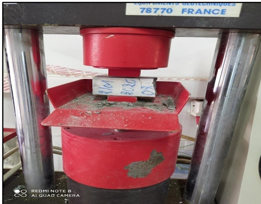
(Figure III.22) : Machine d'essai de résistance à la compression
