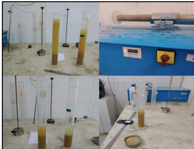
(Figure III.7) : Essai d'équivalent de sable
