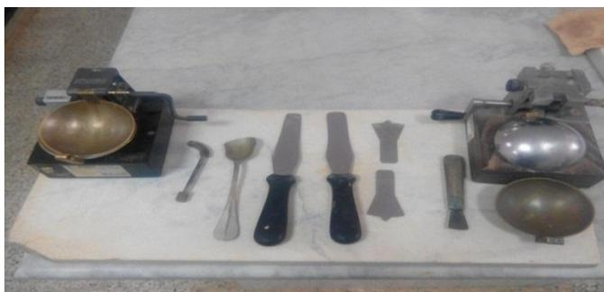
**Photo IV .3 : Appareil de Casagrande**
