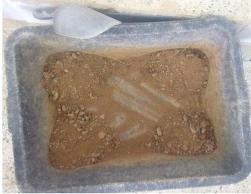
**Photo V.2 :** Bacs d'homogénéisation pour Préparation du matériau
