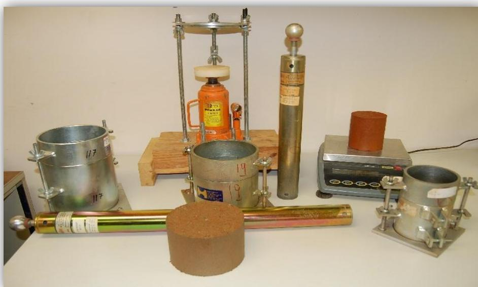
**Photo V.1 : Matériel nécessaire de Proctor Modifié**
