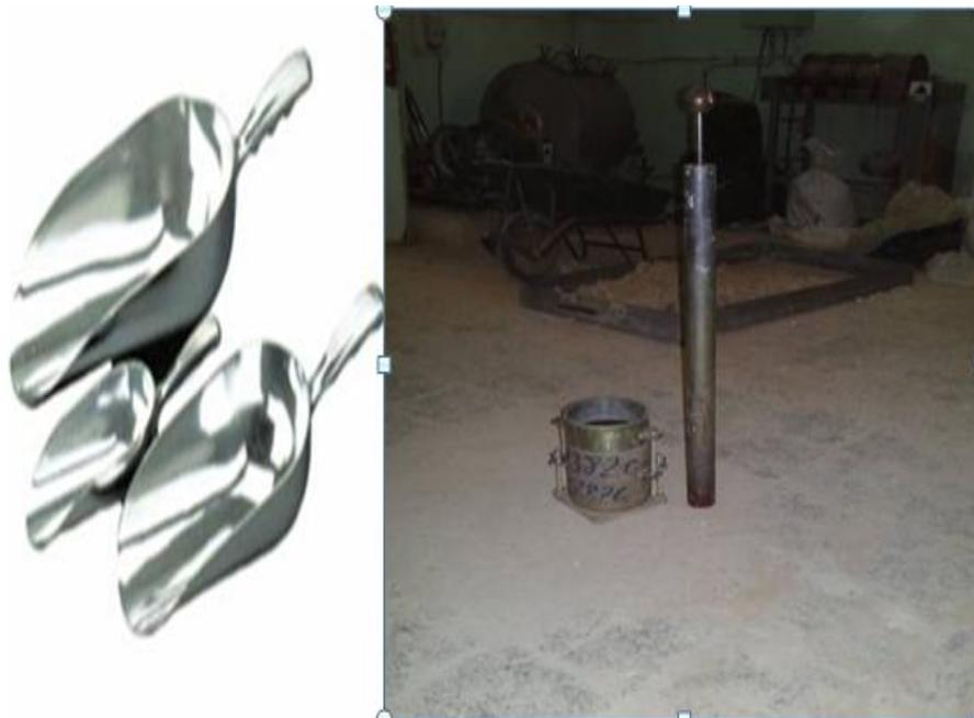
**Photo III.1:** Matériel pour essai de compactage Proctor
