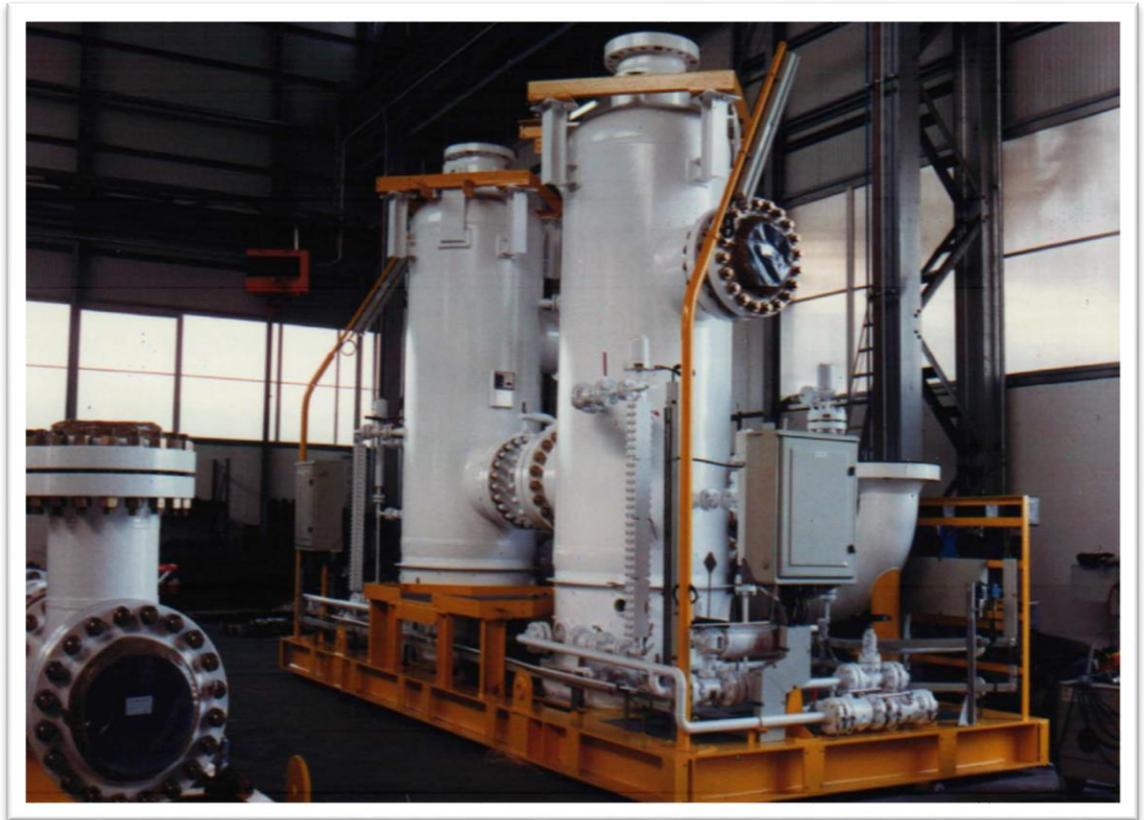
**Figure II.7** Vue extérieure d'un séparateur vertical[9].
