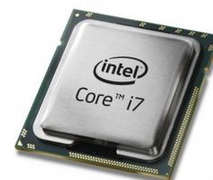
L'UCT (processeur) est constituée de circuits électroniques qui peuvent exécuter des actions primitives (câblées) constituant le jeu d'instructions du processeur appelée encore «langage machine».
