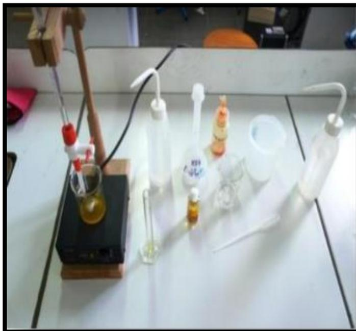
**Figure III.12** : matériel utilisé pour l'indice d'acide.
