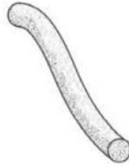
b) nanofibre (2 dimensions externes à l'échelle nanométrique)
