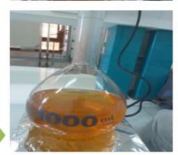
Changement de couleur après l'addition de l'extrait des feuilles de citron avec la solution d'AgNO<sub>3</sub> de 1 mM indique la formation des nanoparticules d'argent
