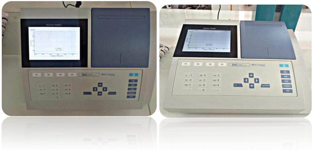
*Annexe 03* : Spectrophotomètre UV- Visible
