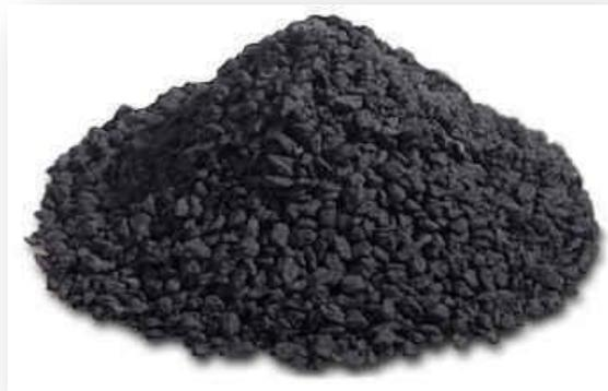
**Figure I. 4** : charbon actif en grain.<sup>11</sup>
