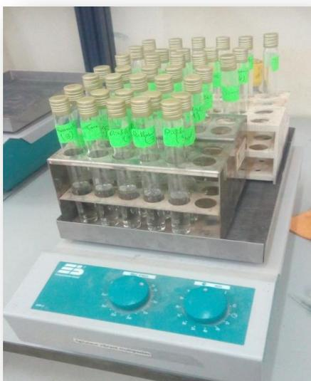
**Figure IV. 2 : Agitateure vibrant multiposte**
