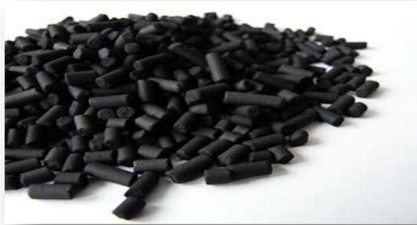
**Figure I.5 : Charbon actif extrudé.**<sup>13</sup>
