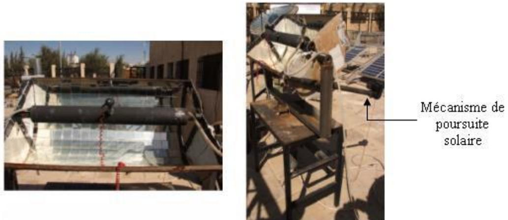
Fig.I.14 : (a) Cuiseur cylindro-parabolique ; (b) système de poursuite solaire,
