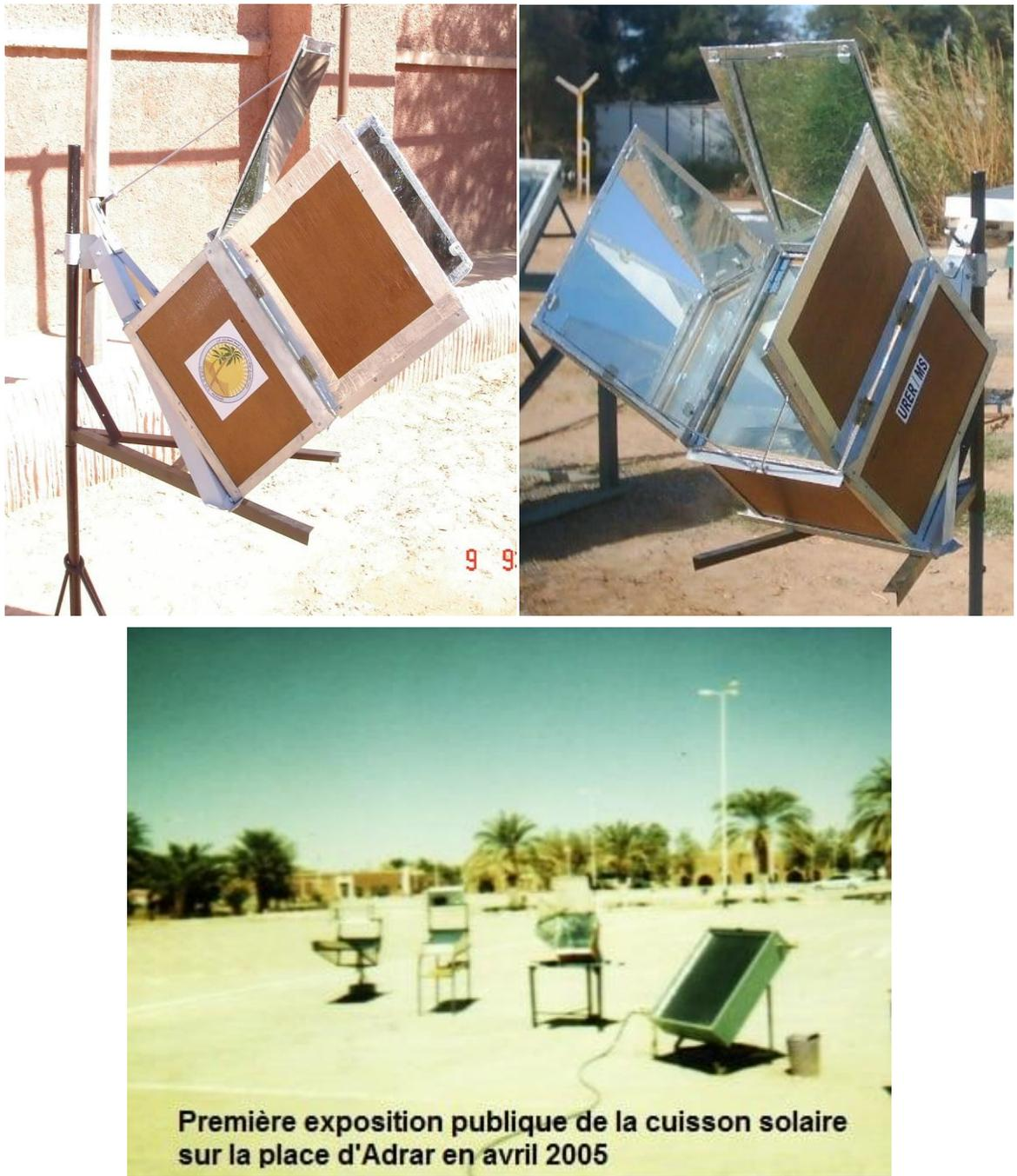
Fig.I.18 : Premier prototype de cuiseur solaire boîte réaliser à L'URERMS, Adrar.
