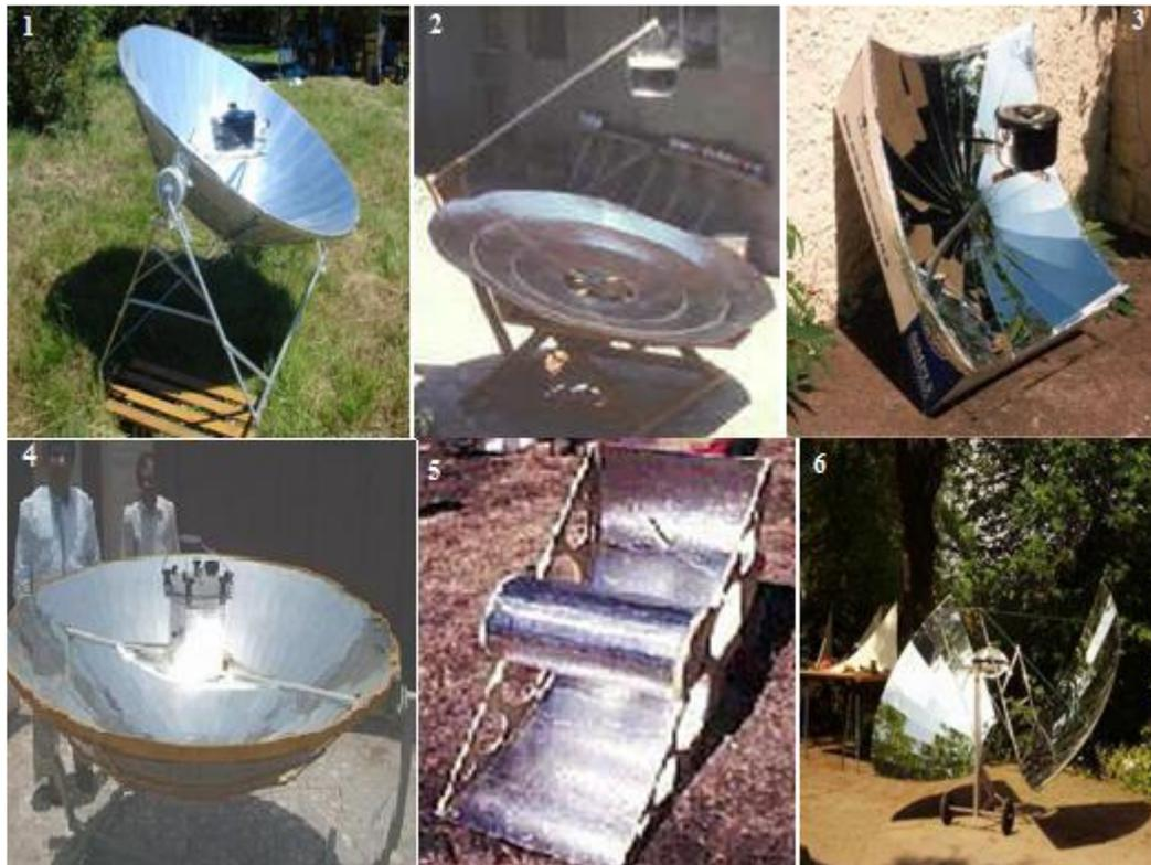
Figure I.9 : Cuiseur solaire à concentration : 1- parabolique, 2- parabolique orienté vers le haut, 3- forme carrée concave, 4- sphérique, 5- cylindro-parabolique, 6- à parois réfléchissantes en forme d'aile.
