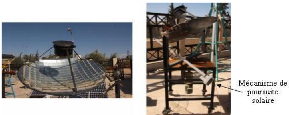
Fig. I.15 :(a) Cuiseur parabolique ; (b) système de poursuite solaire (b),
