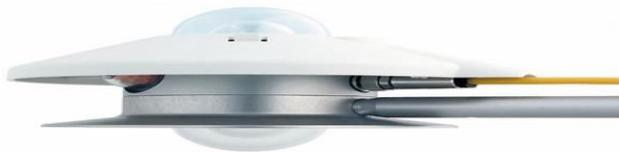
Fig.II.8 : albédo-mètre pour la mesure du rayonnement réfléchi.
