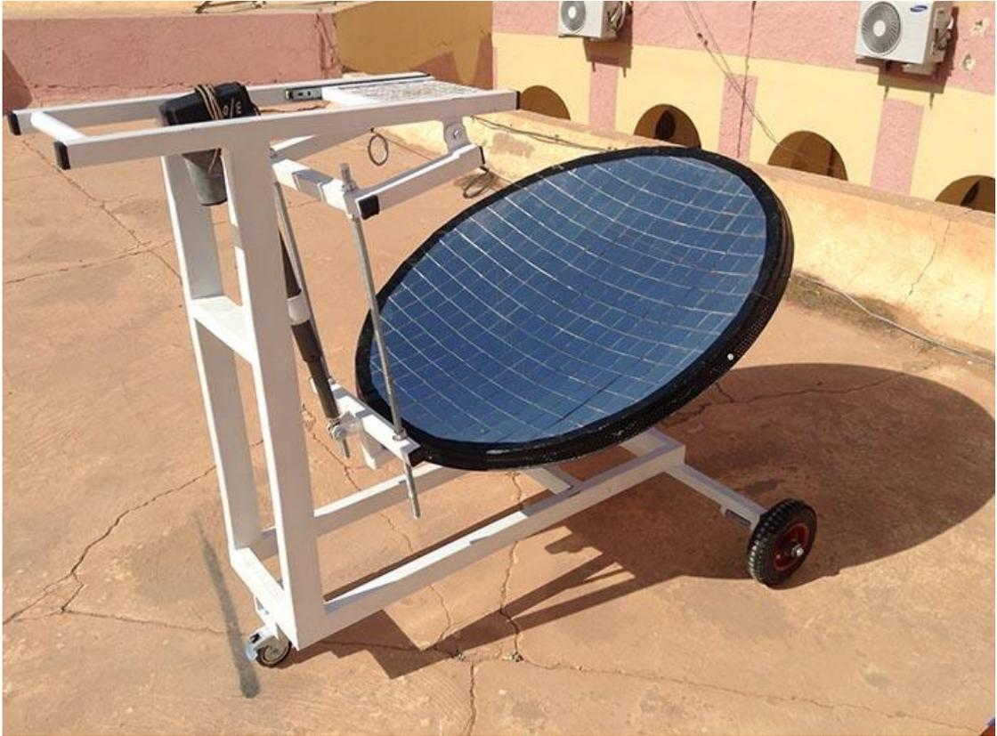
Fig.I.18 :Prototype de cuiseur solaire à Concentration-URAER
