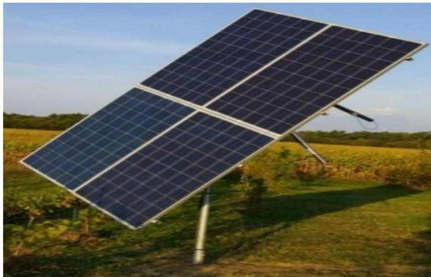
Fig. II.12 : Suiveur à axe horizontale.
