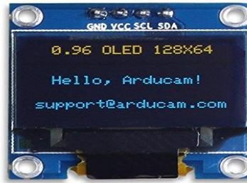
Figure.III.7. Afficheur OLED.
