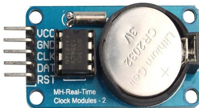
Fig.III.6 : Module Horloge.
