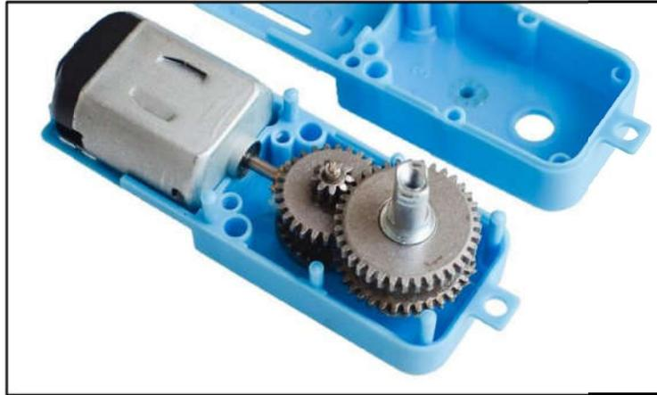
**Figure IV.2.** Moteur à courant continu avec Gearbox
