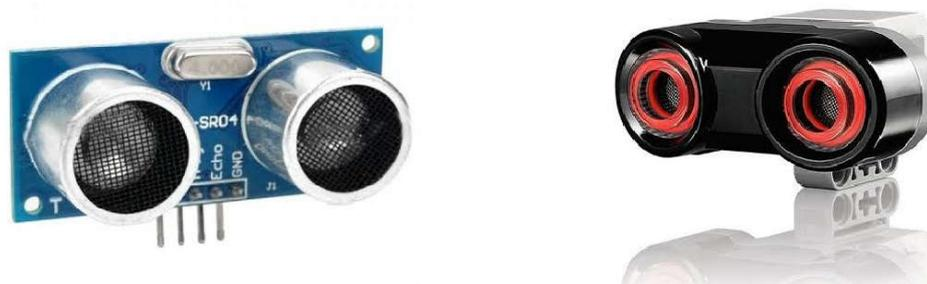
Figure I.5. Capteurs ultrasons
