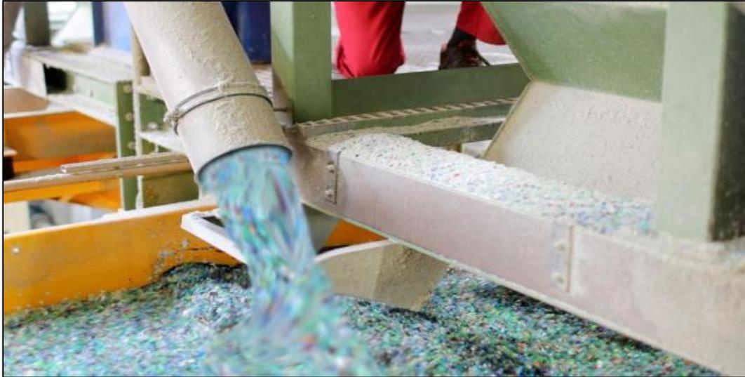
Figure I. 21: Le filtrage des déchets plastiques [28]
