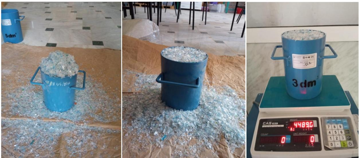
Figure II. 18: Essai de masse volumique apparent de PET
