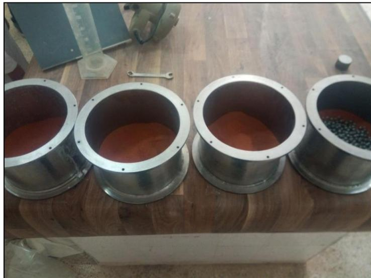
**Figure II. 11: Granulés de brique dans le Moule de la machine de Micro Duval avec granulés de fer**
