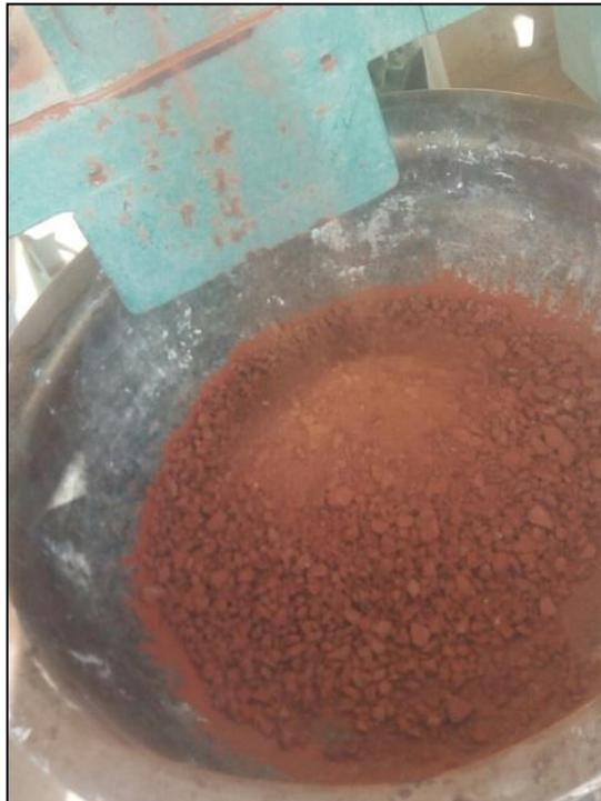
**Figure II. 9: Les granules des briques que nous avons obtenus De la machine los Angeles**
