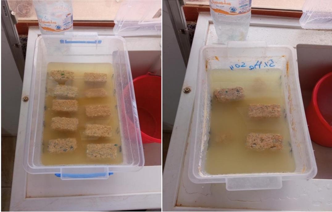
Figure III. 13: Les eprouvettes après 29 jours dans H2SO4
