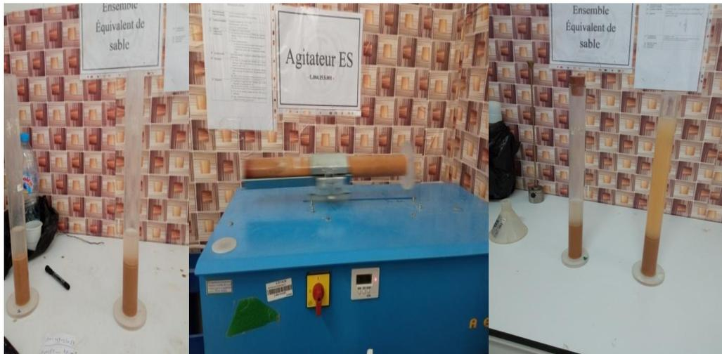
Figure II. 4: Essai d'équivalent de sable de dune utilise
