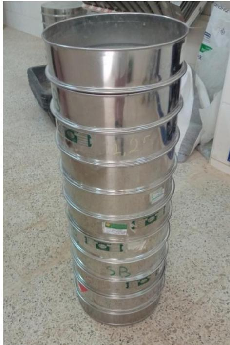
Figure II. 2: Les tamis que nous utilise dans cette essai
