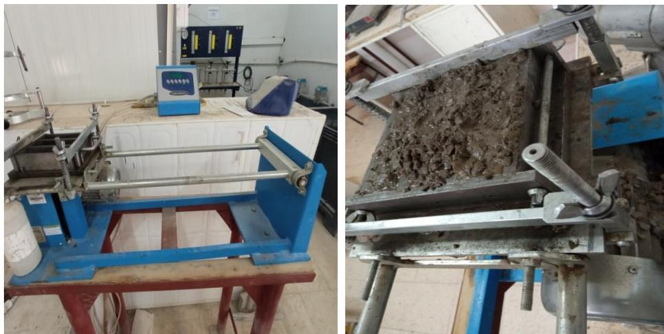
Figure III. 2: Appareil à chocs.
