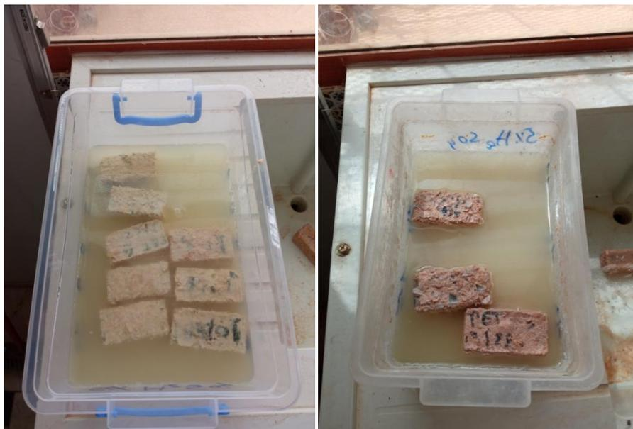
Figure III. 9: Les éprouvettes après 8 jours dans 5% acide H<sub>2</sub>SO<sub>4</sub>
