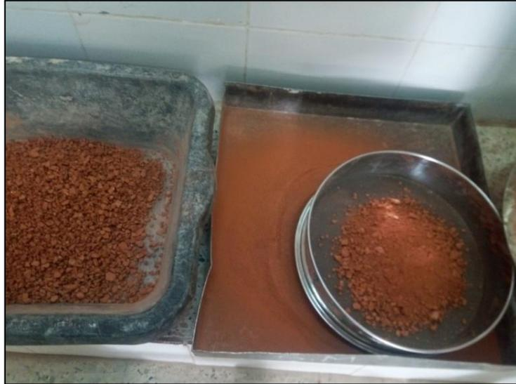
**Figure II. 10: Tamisage de Les granules des briques que nous avons obtenus De la machine**
