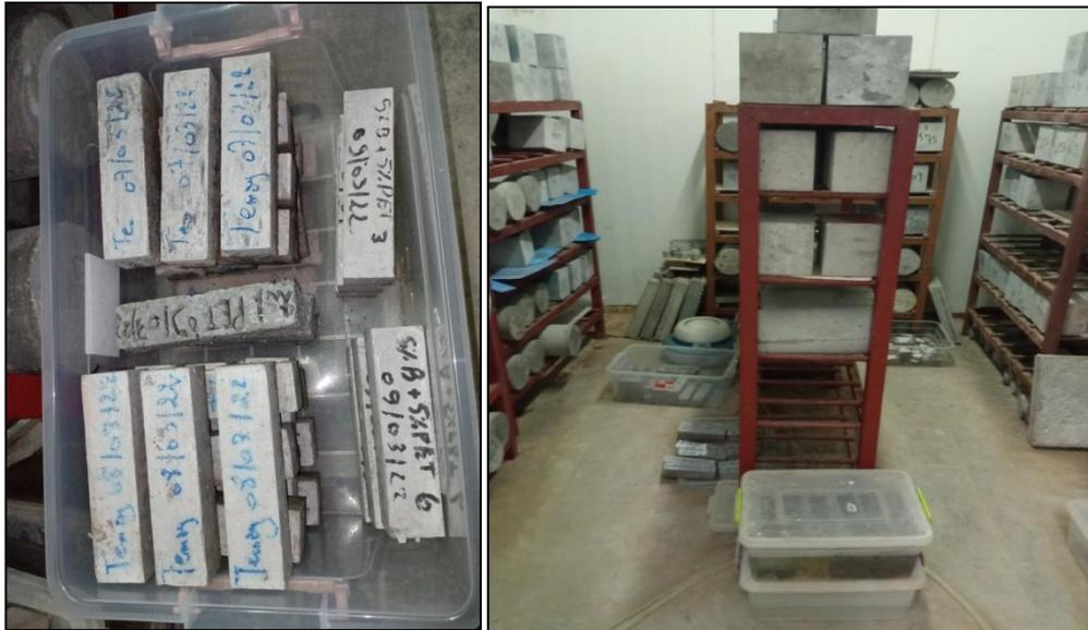
Figure III. 4: Conservation des éprouvettes dans la chambre l'humidité
