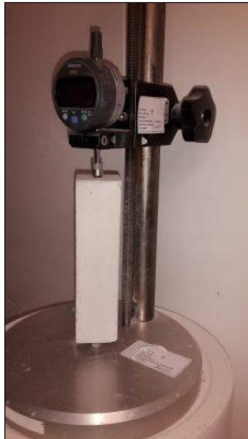
**Figure I. 2: Mesure du retrait sur une éprouvette de béton à l'aide d'un rétractomètre**
