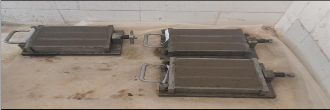
Figure III. 3: Moule normalisé de 40x40x160 mm
