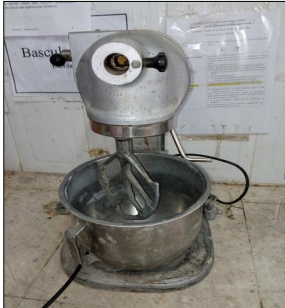
Figure III. 1: Malaxeur normalisé pour pâte et mortier (Labo-LTPS)
