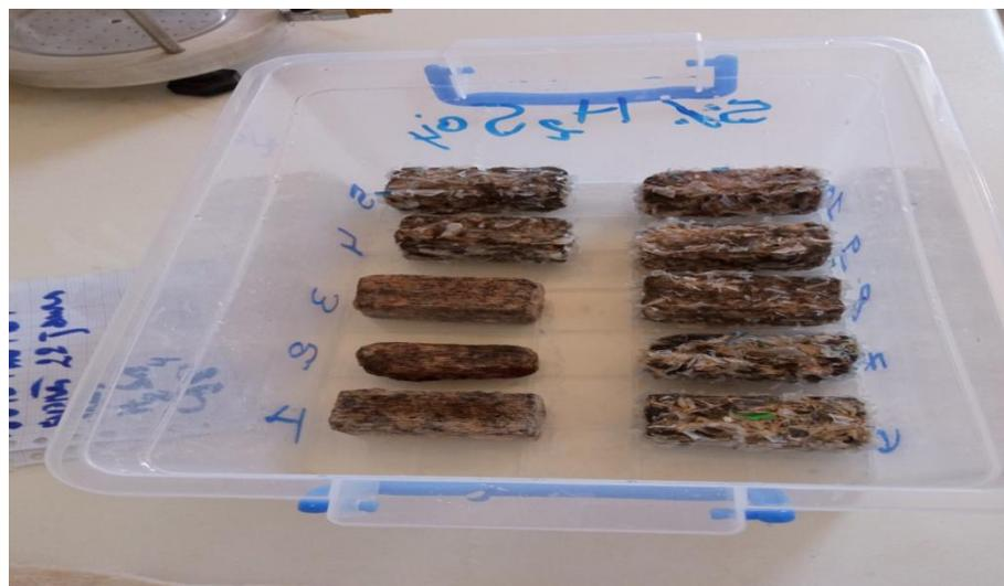
Figure III. 12: Les éprouvettes nettoyées après 22 jours
