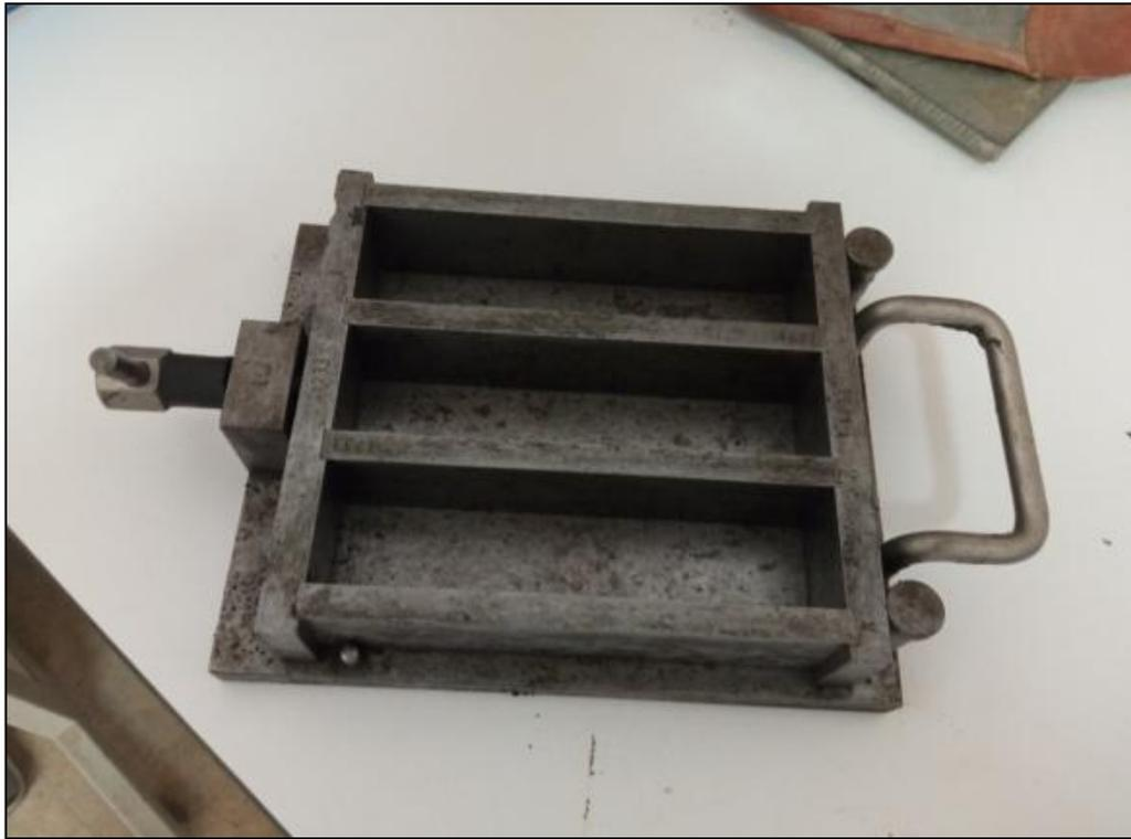
**Figure I. 3: Moule de retrait de mortier 40 x 40 x 160 mm**
