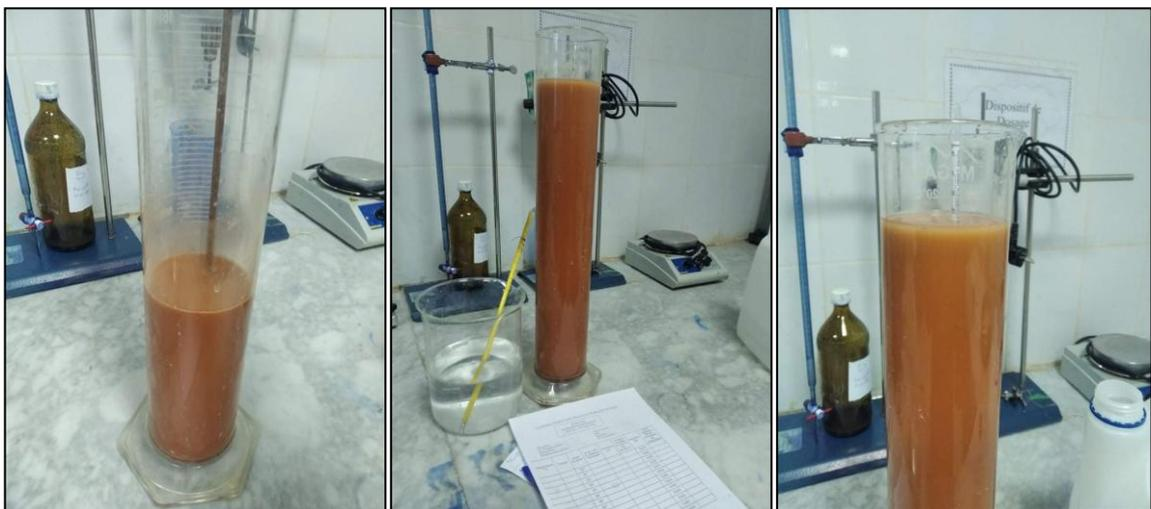
**Figure II. 14: L'essai sédimentométrique**
