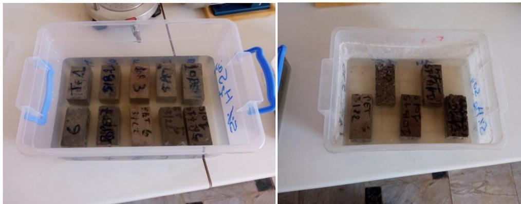
Figure III. 8: Les éprouvettes un jour dans 5% acide H<sub>2</sub>SO<sub>4</sub>
