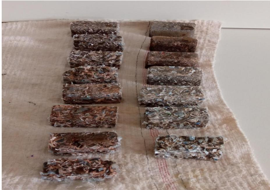
Figure III. 10: Les éprouvettes après nettoyage (8 jours dans l'acide  $H_2SO_4$ )
