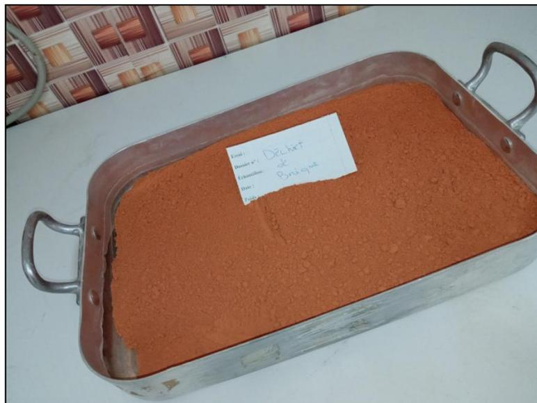
**Figure II. 13: Le déchet brique utilisée**
