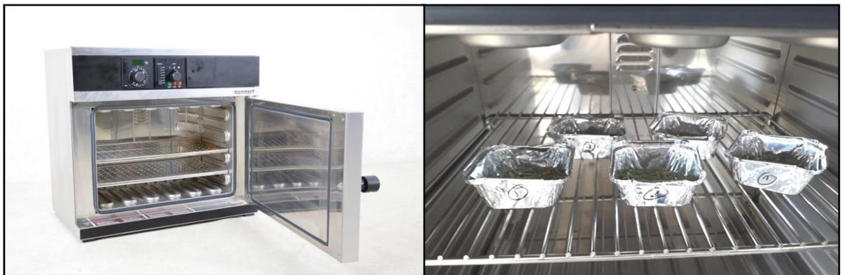
**Figure III.11.** Photographies du l'Etuve utiliser pour déterminer la teneur en matière sèche
