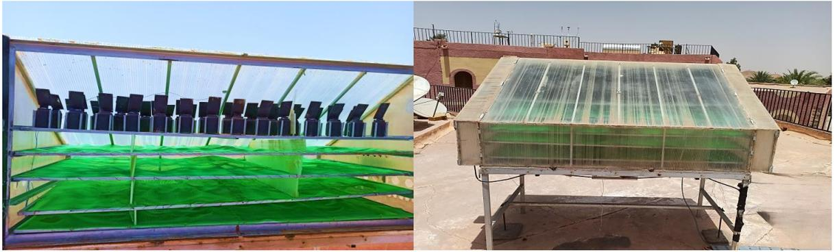
**Figure III.7.** Séchoirs solaire direct de type serre (trapézoïdal)
