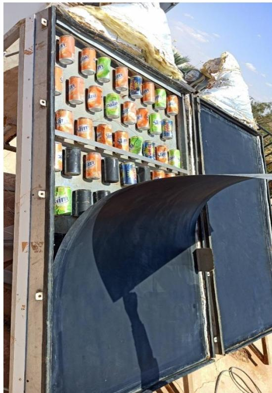
**Figure III.5.** Capture solaire avec MCP
