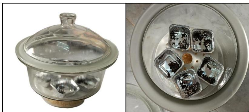
**Figure III.12.** Photographies de dessiccateur utilisé pour déterminer la teneur en eau initiale
