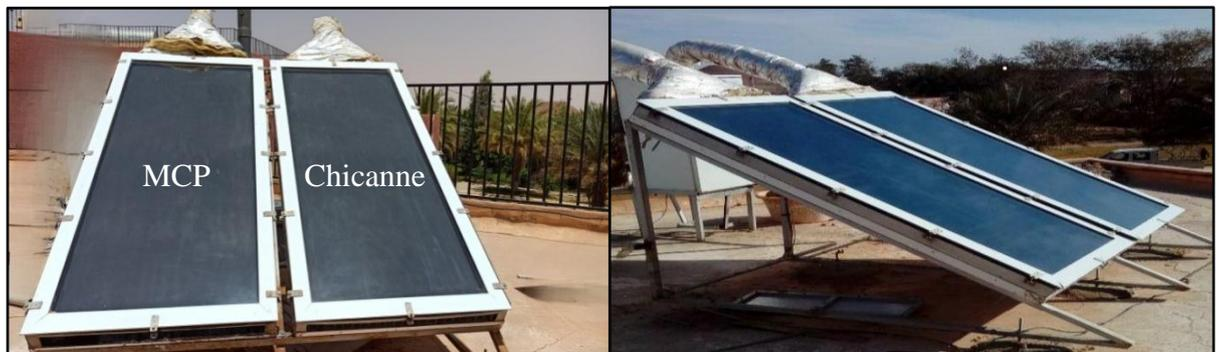
**Figure III.3.** Le prototype utilisé pour sécher *P. scoparius* et *Louisa*. Le modèle de gauche est MCP et celui de droite avec chicanne.
