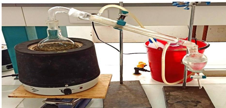
**Figure III.22.** Photo original de montage d'hydrodistillation utilisé.
