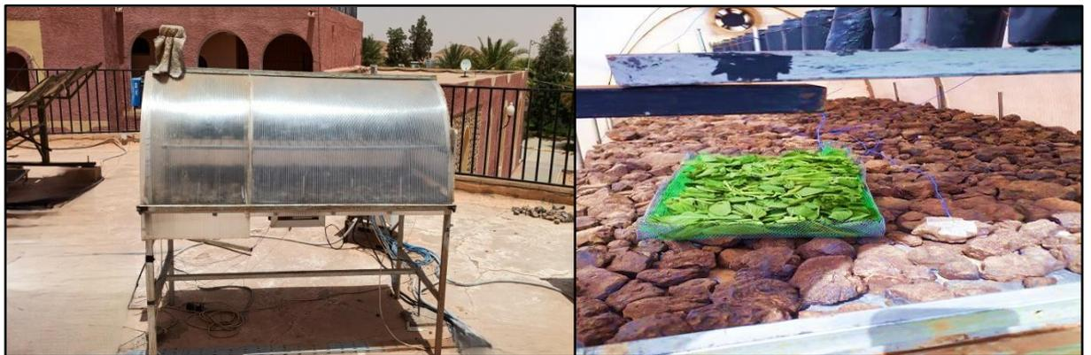
**Figure III.8.** Séchoirs solaire direct de type serre (tunnel)
