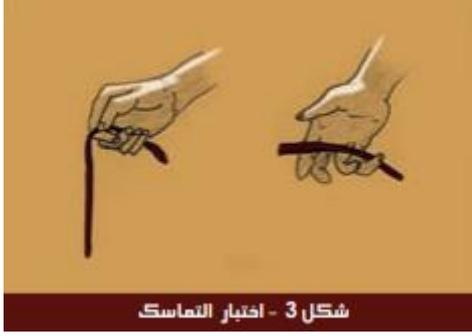
الشكل 16: تجارب جودة الطين – اختبار التماسك
