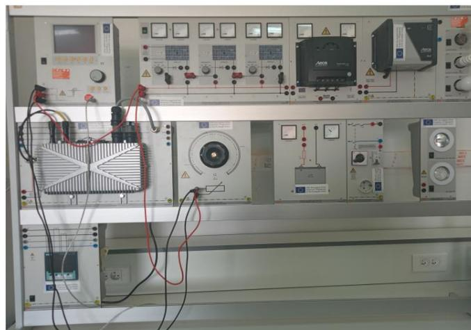
*Figure II.23 : Montage électrique de trois émulateurs de cellule PV montés en série (en pratique)*
