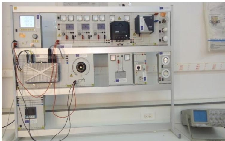
**Figure II.32 :** Montage électrique de trois émulateurs de cellule PV montée en parallèle (T pratique)
