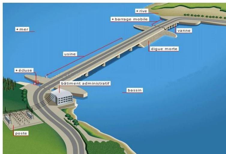
*Figure I.8 : Schéma d'usine marémotrice*
