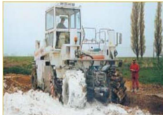
**Fig. I- 11.**— Système d'homogénéisation de sol avant d'ajouter un liant hydraulique.
