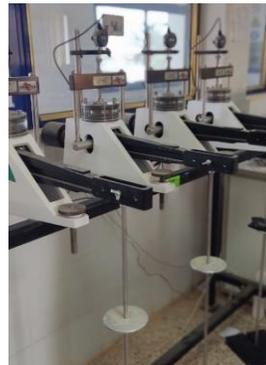
**Fig.IV- 2.—Odomètre uni axial.**
