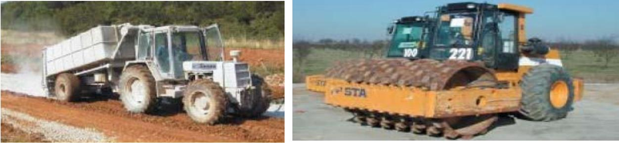
Fig. I- 14.—Epandeur des liants Hydrauliques. Fig. I.— Appareil de compactage du sol.
