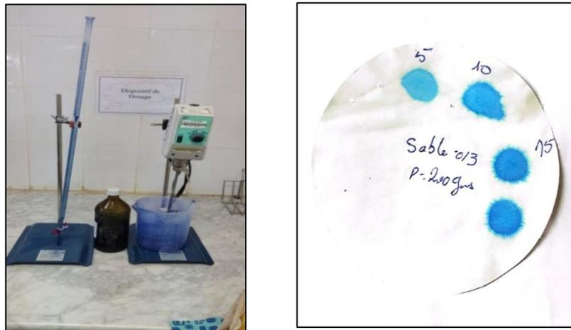
**Fig. III- 11.**—Essai au bleu de méthylène.
