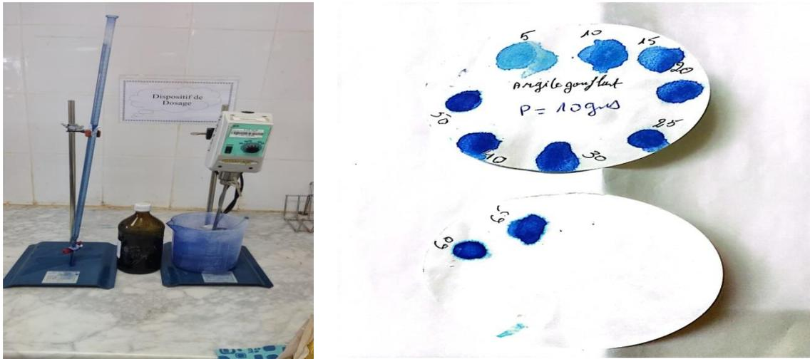
Fig. III- 5.—Essai au bleu de méthylène.
