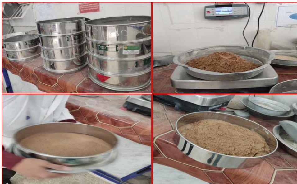
Figure II.3 : L'analyse Granulométrique.
