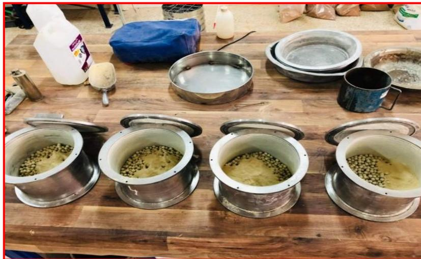
**Figure II.10 :** les boulets à mélanger avec la Bentonite dans les cylindres creux.
