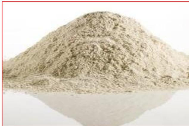
**Figure II.17 :** filler calcaire après le séchage.
