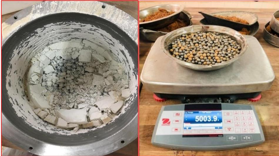
**Figure II.18** : la filler calcaire et les boulets sphériques.
