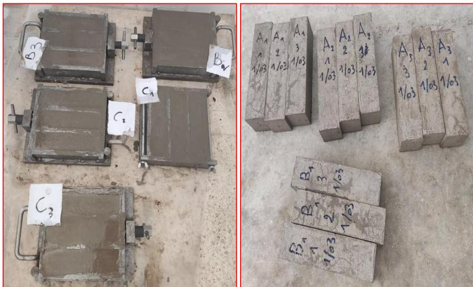
Figure II.21 : Eprouvettes Mortiers de Ciment.
