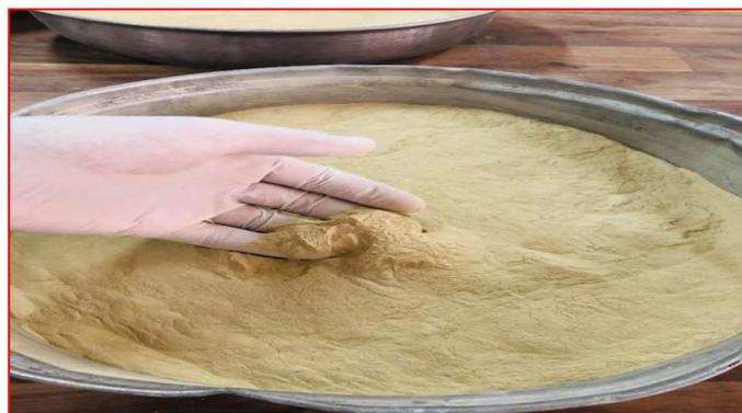
**Figure II.12 :** la bentonite après un broyage mécanique.
