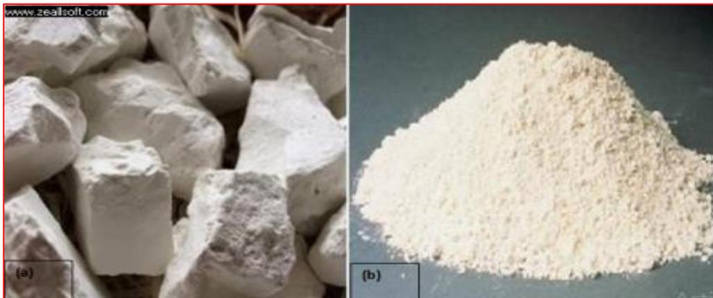
**Figure I.4 :** Pouzzolane artificielle : (a) Kaolin ; (b) Métakaolin.
