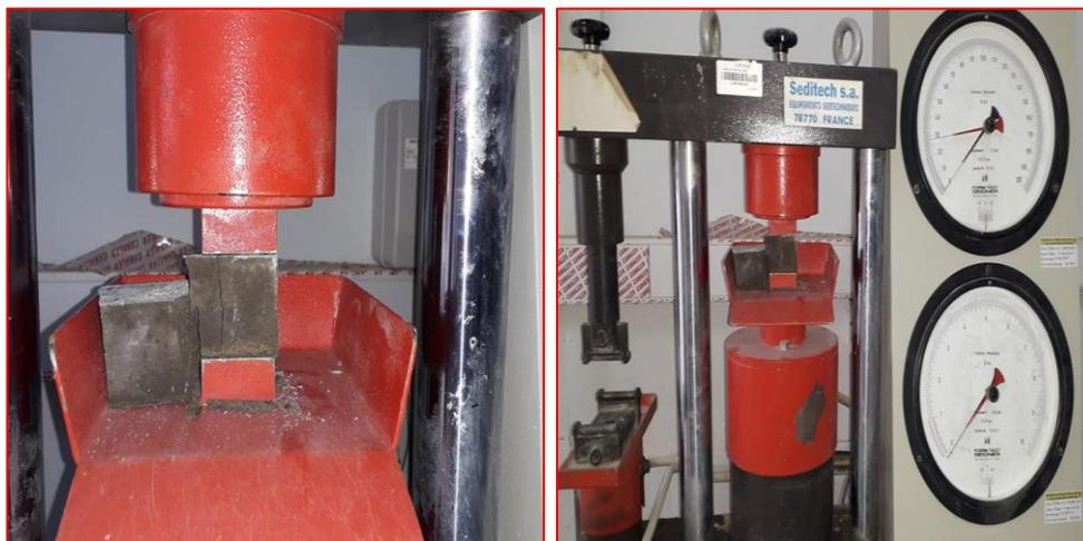
Figure II.24 : Dispositif de résistance à la compression.
