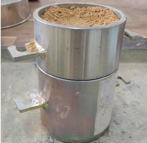
**FIGURE III- 13** moule de Proctor entièrement rempli.
