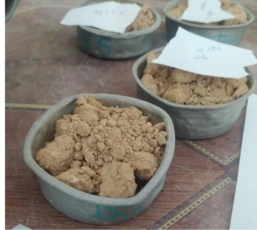
**FIGURE III- 14** échantillons après séchage à étuve 55 ° pendant 48h
