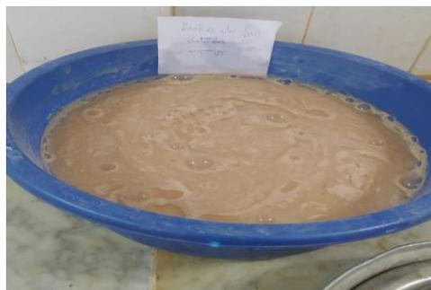
**FIGURE III- 8** : Imbiber dans un récipient d'eau à la température ambiante notre échantillon
