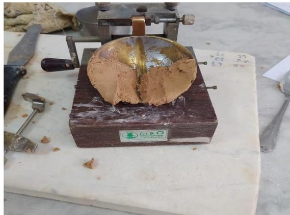
**FIGURE III- 9** Détermination la Limite de Liquidité
