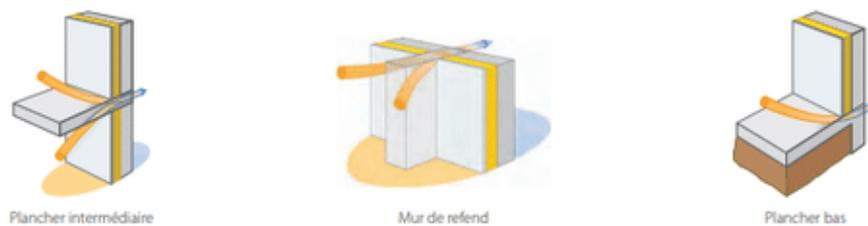
Figure 3.9 : Ponts thermique de liaison Source : [30]
