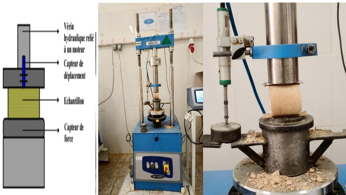
*Photo IV-11 : Schéma de principe d'écrasement par fendage.*
