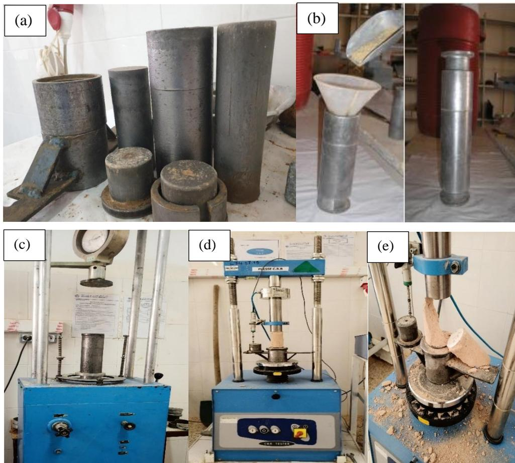
**Photo III-7 :** (a) Moules de confection ; (b) Préparation des éprouvettes ; (c) Presse hydraulique ; (d) Ecrasement d'éprouvette par la presse CBR ; (e) éprouvette écrasée.
