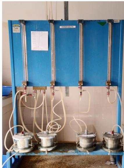
*Photo IV-5: Essai de perméabilité à charge variable.*
