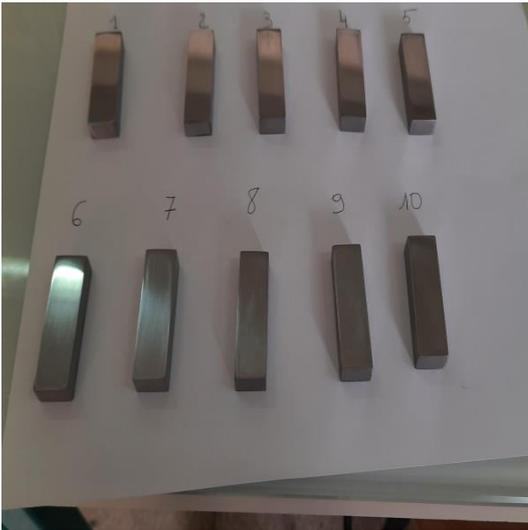
**Photo VI.1:** L'échantillon avant immersion
