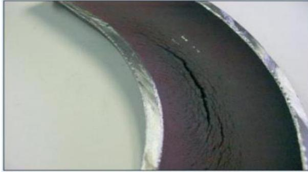
**Figure III.11** :Défaillance par la fatigue- corrosion d'un tube d'économiseur à basse pression.[36]
