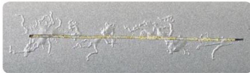
**Figure III.10 :** Corrosion filiforme sur un échantillon d'aluminium peint et scarifié.[35]
