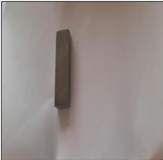
**Photo V.5:** Acier X70 avant le polissage
