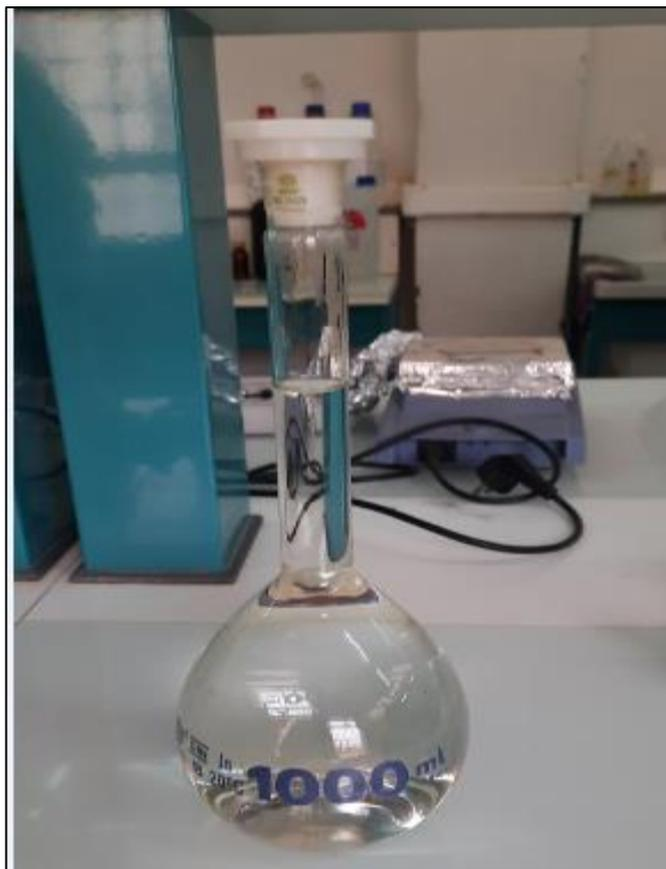
**Photo V.8:** le milieu corrosif acide chlorhydrique 1M (HCl)
