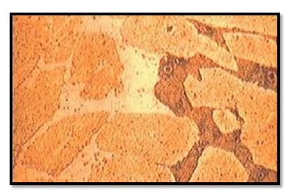
Figure08: corrosion sélective [8].
