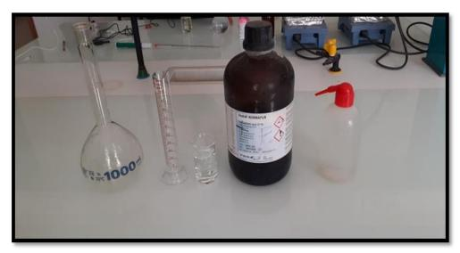
**Photo 01:** Préparation d'une solution de HCl 1M.
