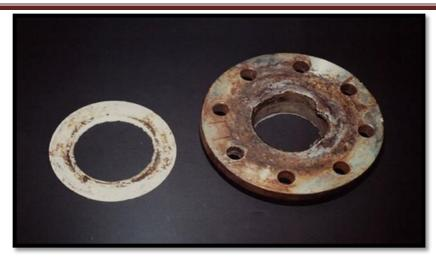
Figure07: corrosion caverneuse [8].
