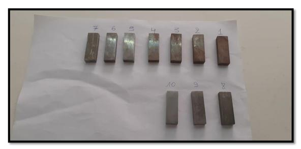
**Photo 21:** L'échantillon avec l'inhibiteur (après 20min d'immersion).
