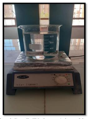
**Photo 08:** Chauffage de l'eau distillée dans un Agitateur Magnétique Chauffant.
