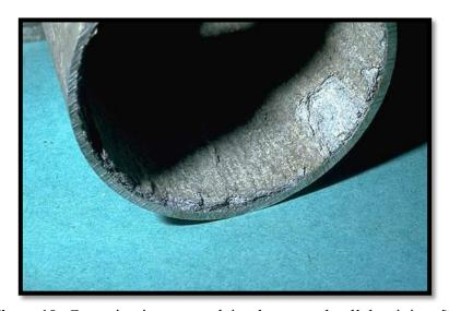
**Figure 10:** Corrosion inter granulaire dans un tube d'aluminium [8].
