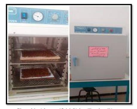
**Photo 06:** séchage artificiel d'échantillon dans l'étuve.
