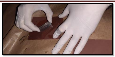
**Photo 17:** Polissage manuelle d'acier X70.
