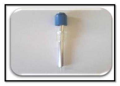
**Figure 05:** Electrode d'auxiliaire travail [12].
