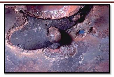
**Figure05:** corrosion galvanique [8].
