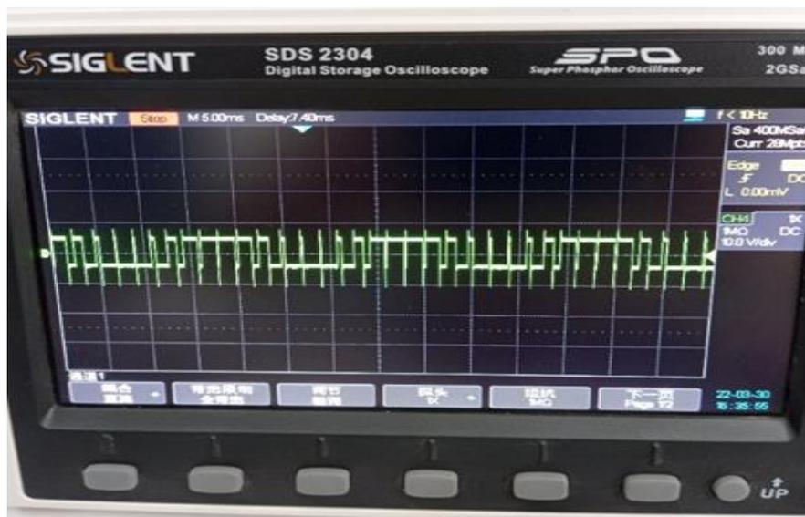
**Figure III.16. Tension de sortie de l'onduleur ( $V_s/10$ )**
