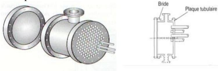
Figure III.2 Figure d'une plaque tubulaire [27]
