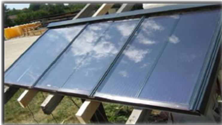
**Figure II.7** Le capteur solaire PV/T hybride à eau [26]
