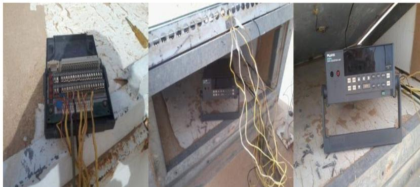
**Figure IV.15** Photos représentent le raccordement des différents thermocouples à l'acquisition de données
