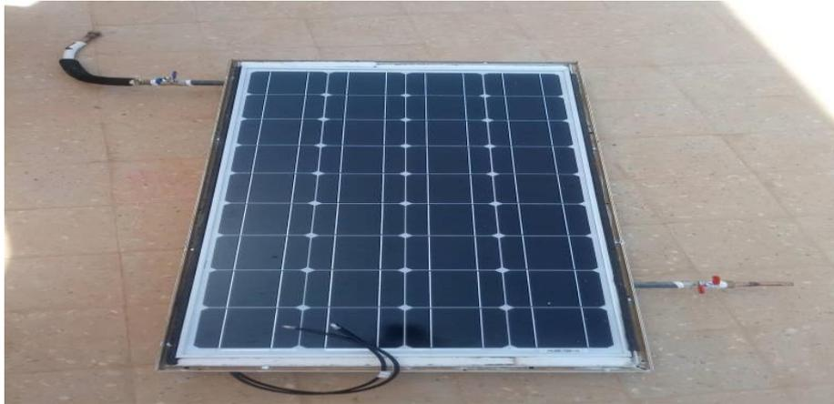
**Figure IV.8** Le capteur hybride PV/T à eau
