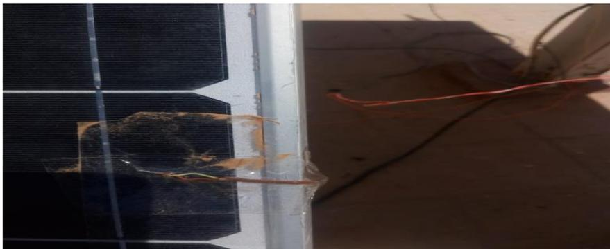
**Figure IV.10** L'emplacement du thermocouple sur le capteur PV-T
