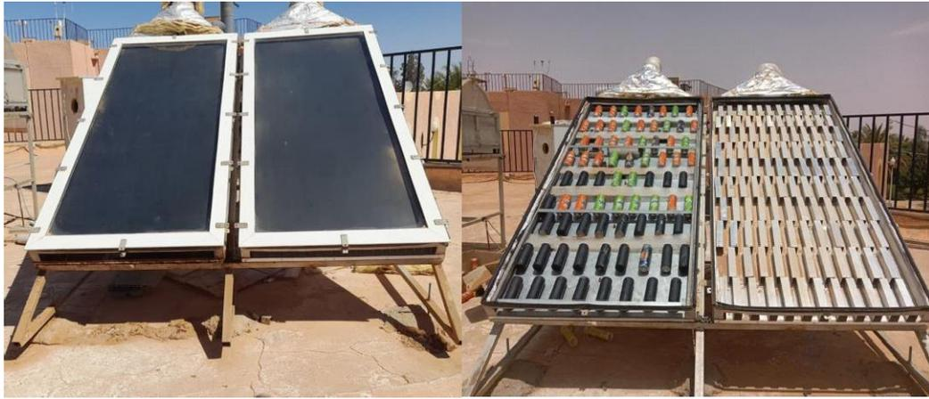
**Fig. (III. 4) :** capteurs solaires avec cannettes et avec chicanes
