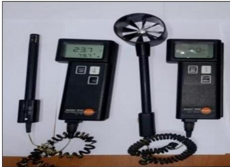
Fig. (III.12) : Anemometer Testo 440 + thermo-hygromètre Testo 610
