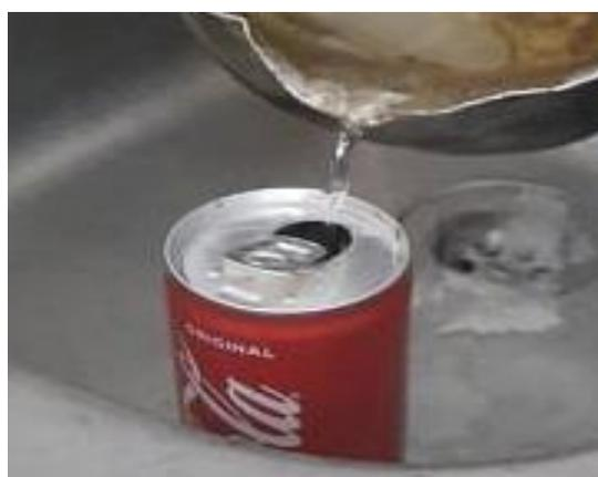
Fig. (III.30) : Matériau préparé pour le stockage de l'énergie thermique remplissage des cannettes par chlorure de calcium ( $\text{CaCl}_2, 6\text{H}_2\text{O}$ )
