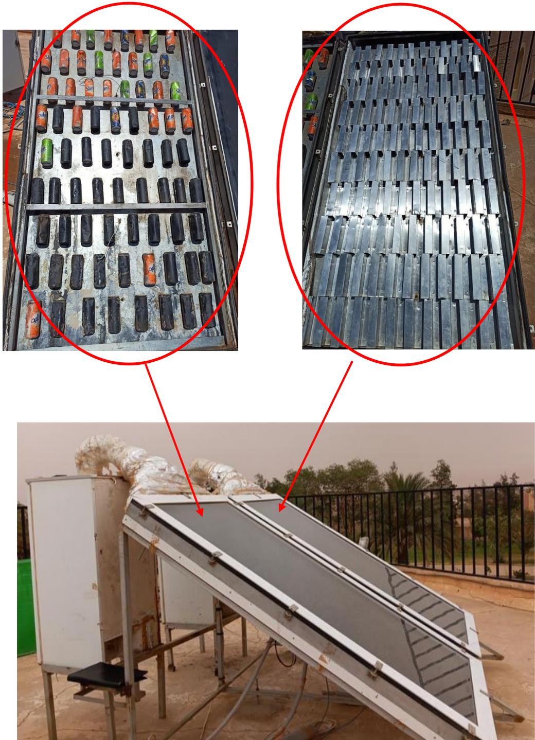
Fig IV.2 : Prototypes de séchoir solaire indirect : avec système de stockage d'énergie thermique par chaleur latente (gauche) et muni des chicanes (droite).
