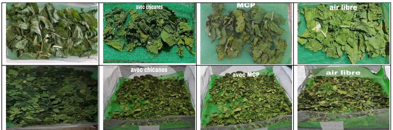
Fig IV.13 Vue photographique d'échantillons des feuilles de bettes et de moringa frais, séchés à l'air libre et aux prototypes de séchoir solaire indirect muni des chicannes et avec MCP
