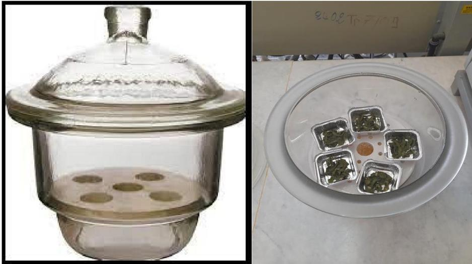
**Fig. (III.14)** : Photographies de dessiccateur utilisé pour déterminer la teneur en eau initiale
