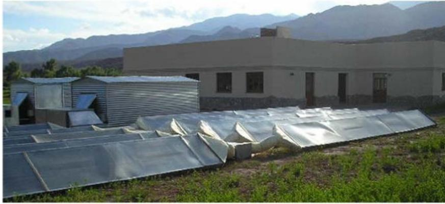
**Fig.I.28** Photographie de séchoir solaire. Le réseau de collecteurs, l'armoire de ventilateur et la chambre de séchage sont montrés [41]
