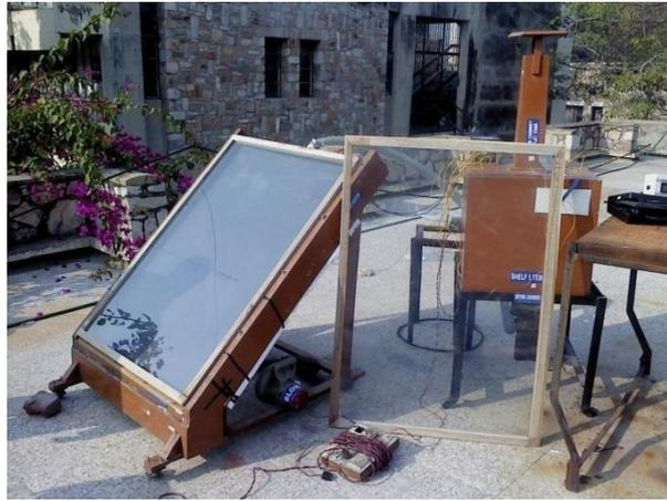
**Fig.(I.8)** : Photographie d'un réchauffeur d'air solaire, d'un séchoir d'armoire et de deux cadres de vitrage [24]
