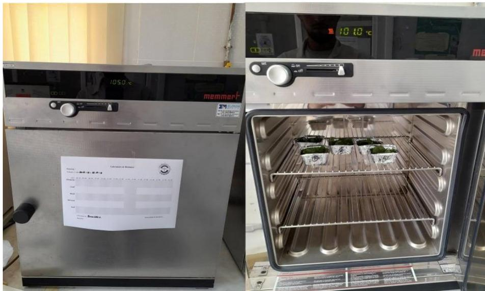
**Fig. (III.15)** : Photographies du l'Etuve utiliser pour déterminer la teneur en matière sèche
