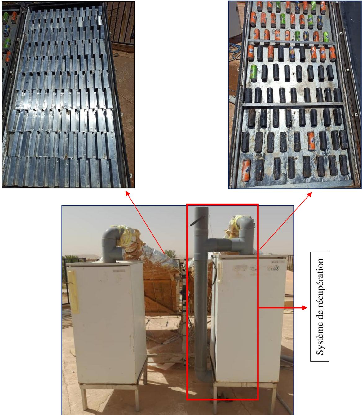
Fig IV.7 : Prototypes de séchoir solaire indirect : avec système de stockage d'énergie thermique par chaleur latente (gauche) et muni des chicanes (droite).
