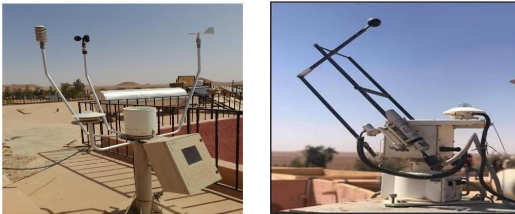
**Fig. (III.11)** : Photographie des Appareillages de mesures de rayonnement, température et d'humidité relative de l'air ambiant
