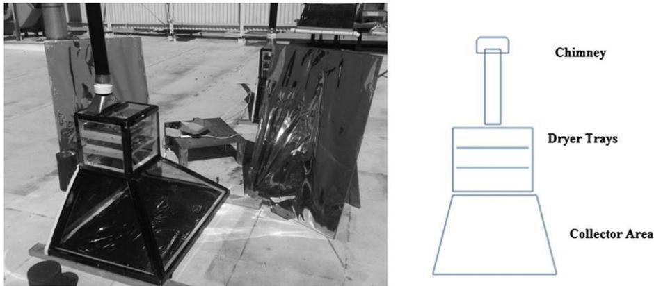
**Fig.(I.11) :** Séchoir solaire et deux panneaux de réflexion solaire à concentration utilisés dans des expériences de séchage. L'instrumentation d'enregistrement des données pour les capteurs est située sur la table basse [27]
