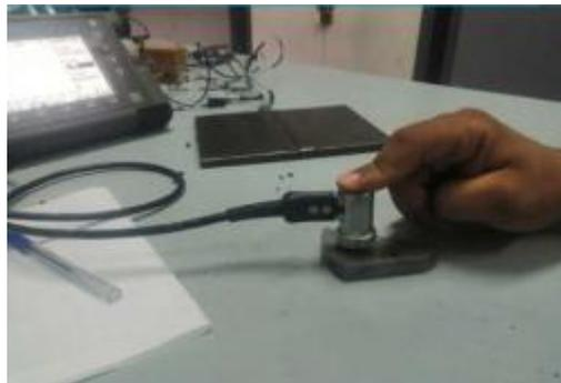
Figure IV.35 Étalonnage de l'appareil à ultrasons par palpeur droit.
