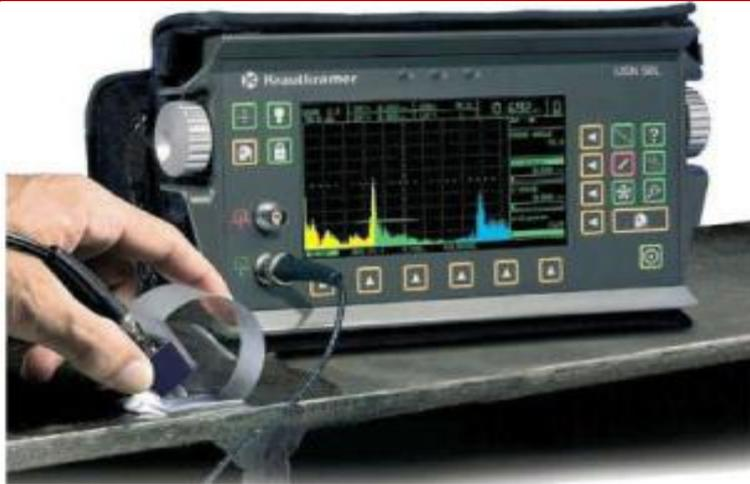
**Figure III.8** Détecteur à ultrasons manuel.
