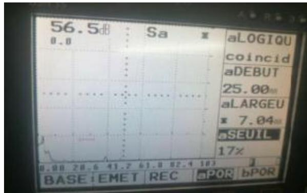
Figure IV.39 photos pour un essai sans faute.
