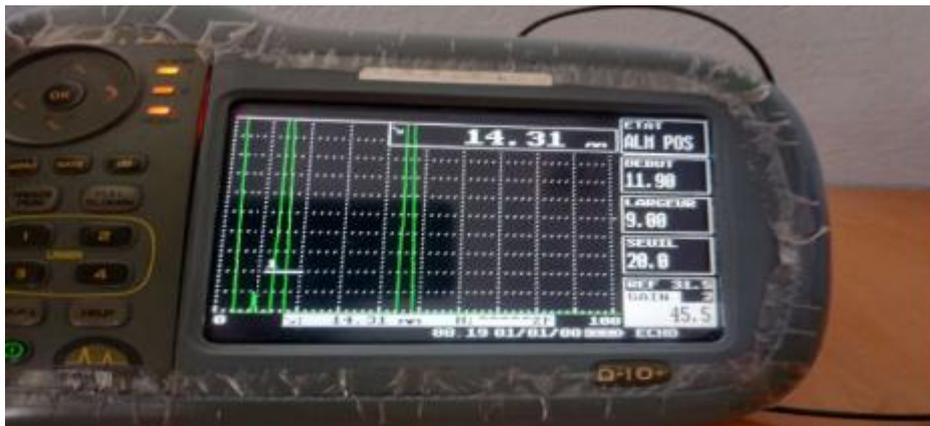
Figure IV.16 résolution obtenue par un palpeur droit.
