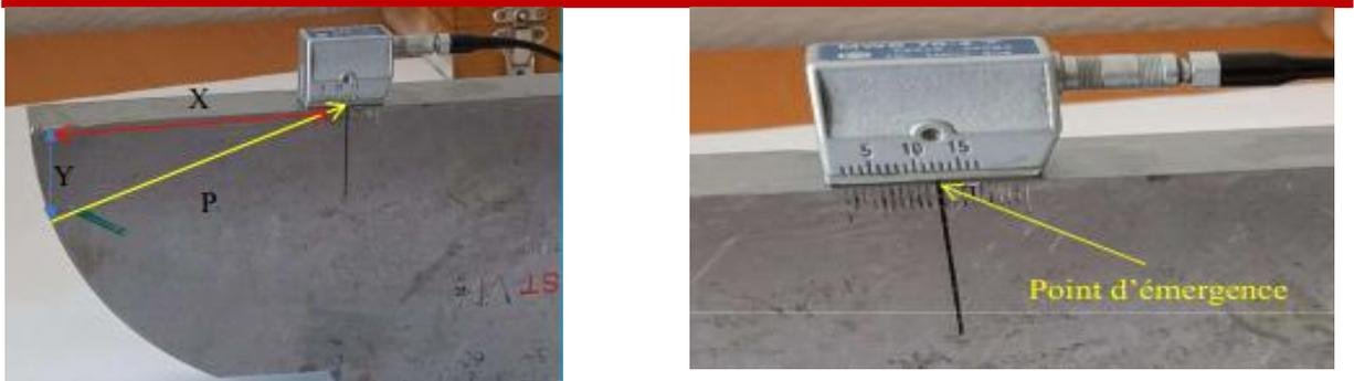
**Figure IV.23** Position de point d'émergence.
