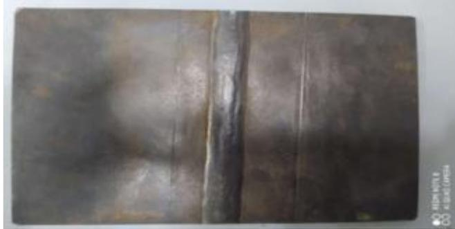
Figure IV.8 Plaque en acier assemble par soudage.
