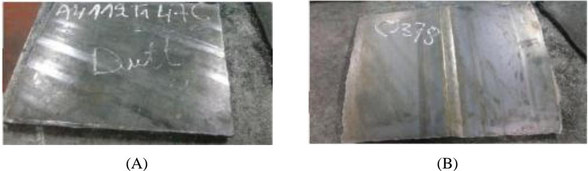
**Figure IV.3** (a) Plaque "1" totalement en métal de base (b) Plaque "2" contenant le cordon de soudure.
