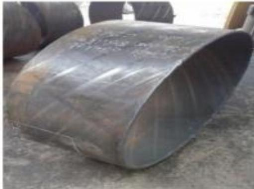
**Figure IV.1** Une virole découpée à partir d'un tube.
