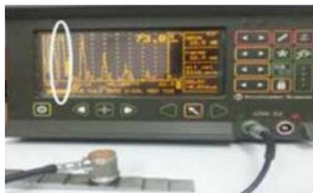
Figure IV.21 détermination de la zone morte de notre palpeur.
