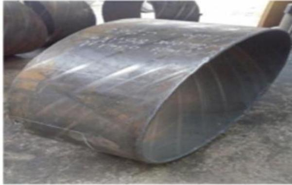
**Figure IV.5** Une virole découpée à partir d'un tube.
