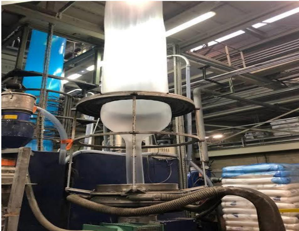
**Fig. III.9.** Exemple d'Extrusion-gonflage de films
