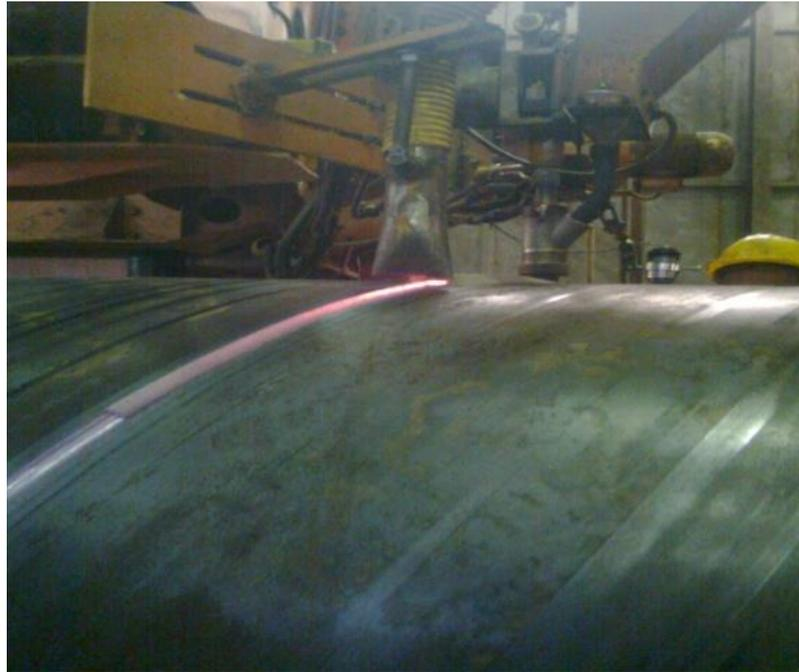
**Fig. I.6.** Machine a souder en spirale
