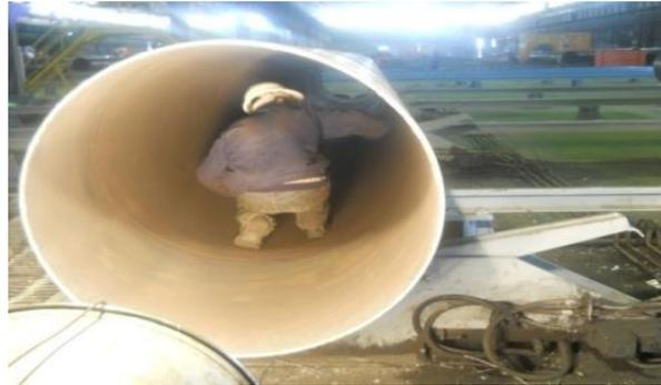
**Fig. I.7.** Contrôle visuel du tube
