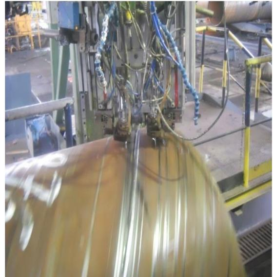
**Fig. I.9.** Tube à examination par ultrasons
