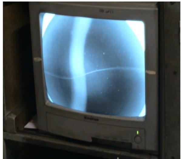
**Fig. I.8.** Contrôle Radioscopique du tube
