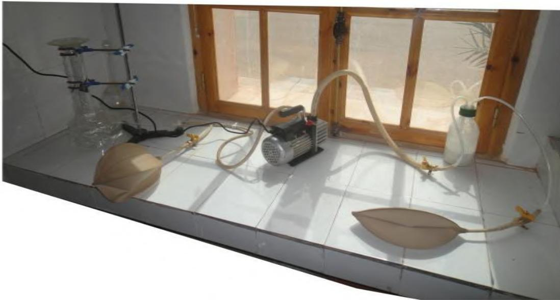
Photo 05: Système de mesure du volume du biogaz et de  $\text{CH}_4$ (BMP).
