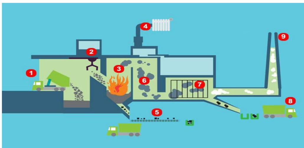
**Figure 04 : Schéma d'une installation d'incinération des déchets. [29]**
