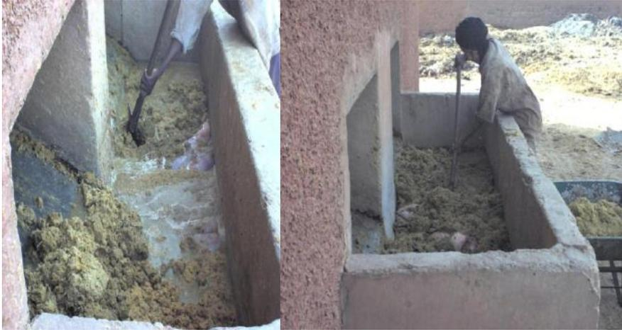
**Les déchets d'abattoirs utiliser pour l'alimentation de digestion continue à l'échelle pilote.**
