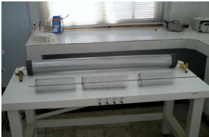
**Filtre de sulfure d'hydrogène H<sub>2</sub>S utilisé.**
