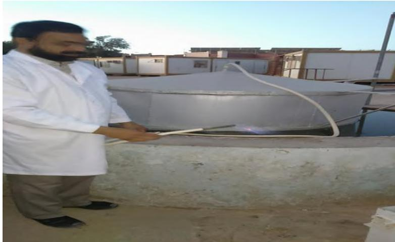
**Photo 06: Test d'inflammabilité du biogaz.**
