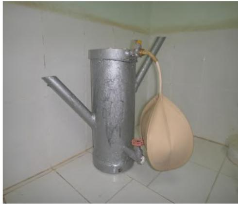
**Photo 01: Digesteur continu à l'échelle du laboratoire.**
